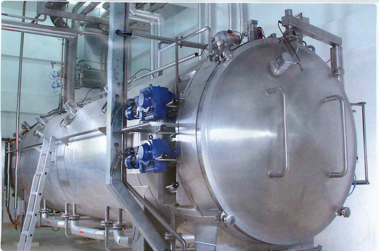
Bild 1: Das Aushärten der Faserverbundwerkstoffteile erfolgt unter Vakuum bei 125-150°C in einem Autoklav.
