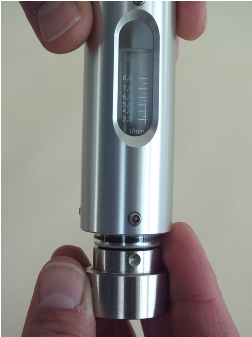
Abb. 46: Verschraubung in Gerätehülse schieben
