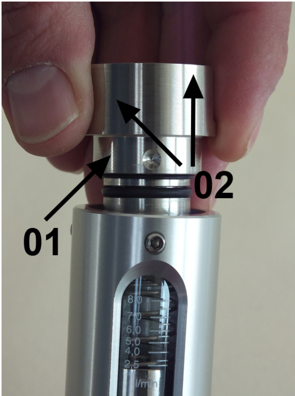
Abb. 50: Verschraubung (Ausgang) in Gerätehülse einsetzen
