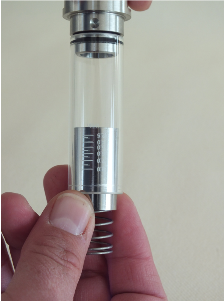
Abb. 39: Schwebekörper, Magnete und Feder entnehmen
