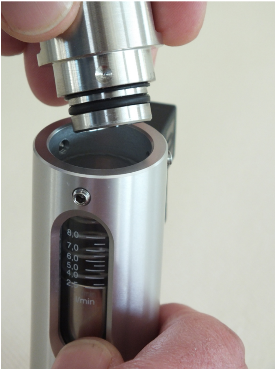
Abb. 36: Verschraubung (Ausgang) abnehmen
