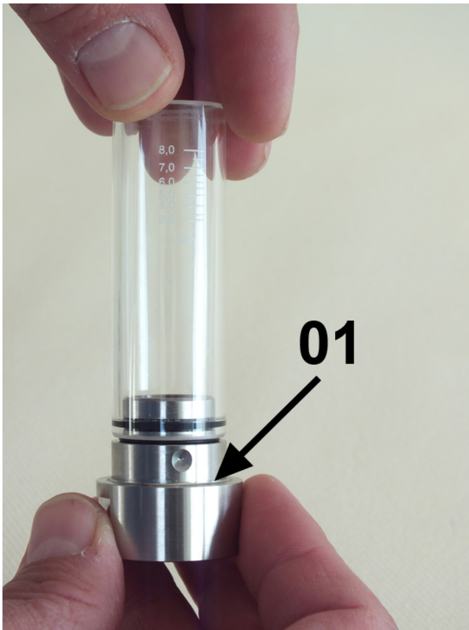
Abb. 44: Verschraubung (Eingang) in Schauglas
