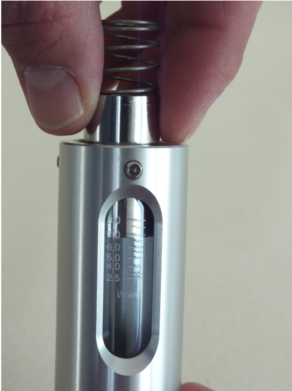
Abb. 49: Schwebekörper und Innenteile einführen
