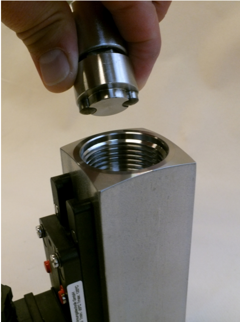
Abb. 45: Eindrehwerkzeug Gewinding (Eingang) einführen
