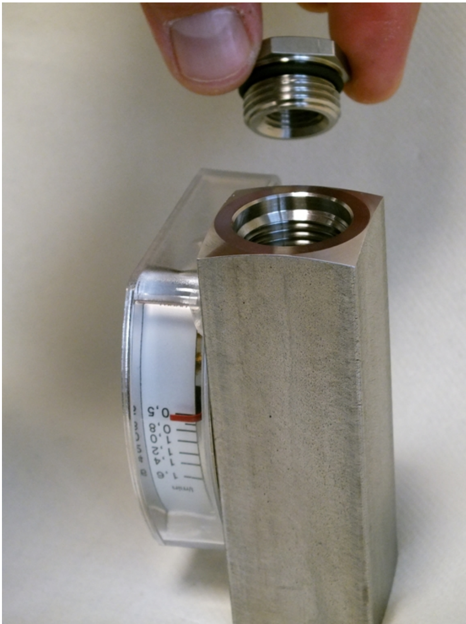
Abb. 50: Verschraubung (Eingang) abnehmen
