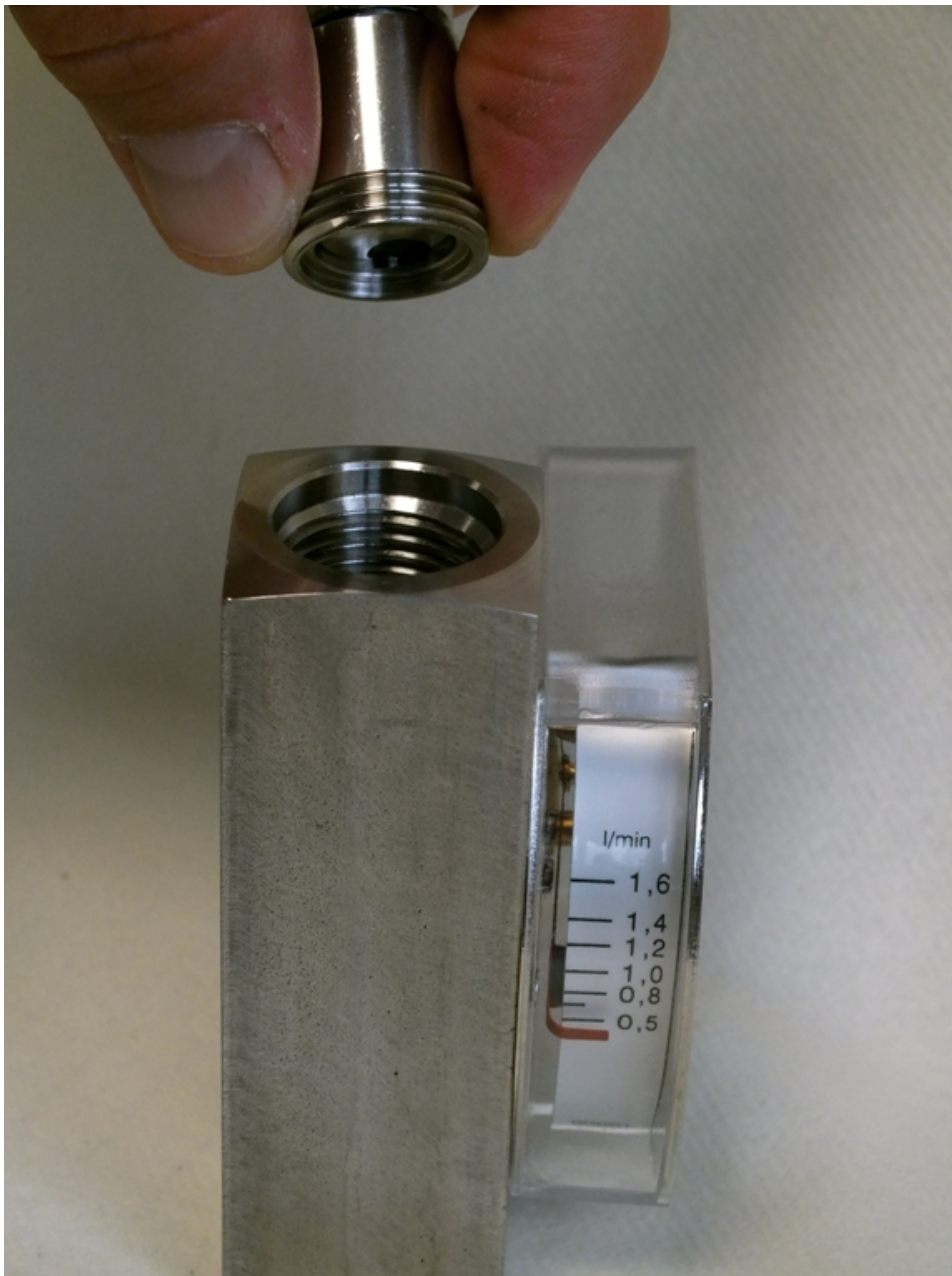
Abb. 46: Gewinding (Ausgang) entnehmen
