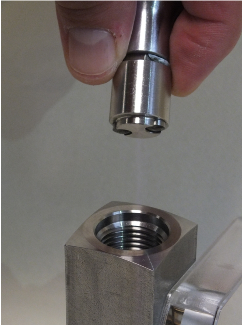
Abb. 44: Eindrehwerkzeug-Gewinding einführen (Ausgang)
