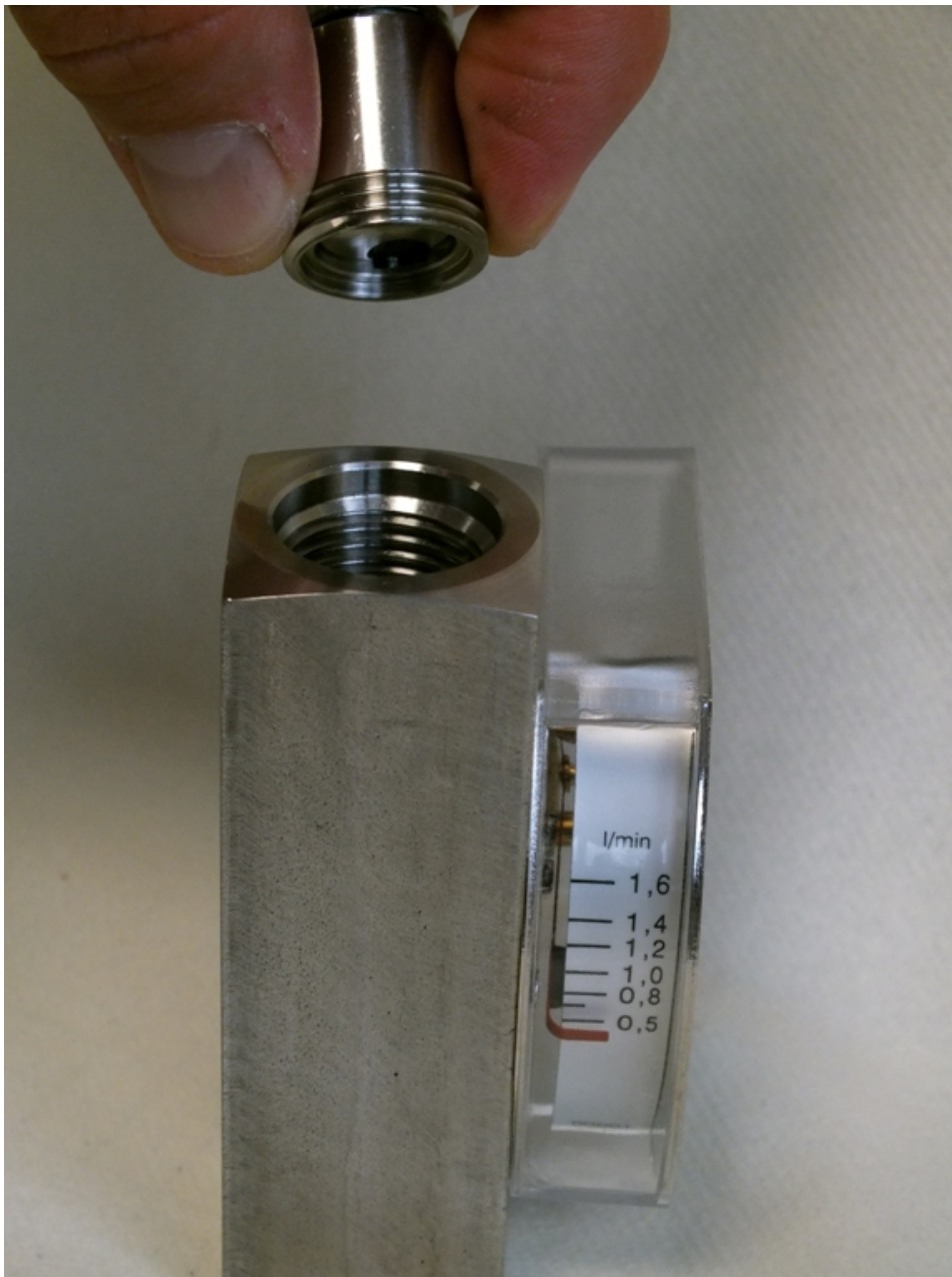
Abb. 56: Gewinding (Ausgang) einführen
