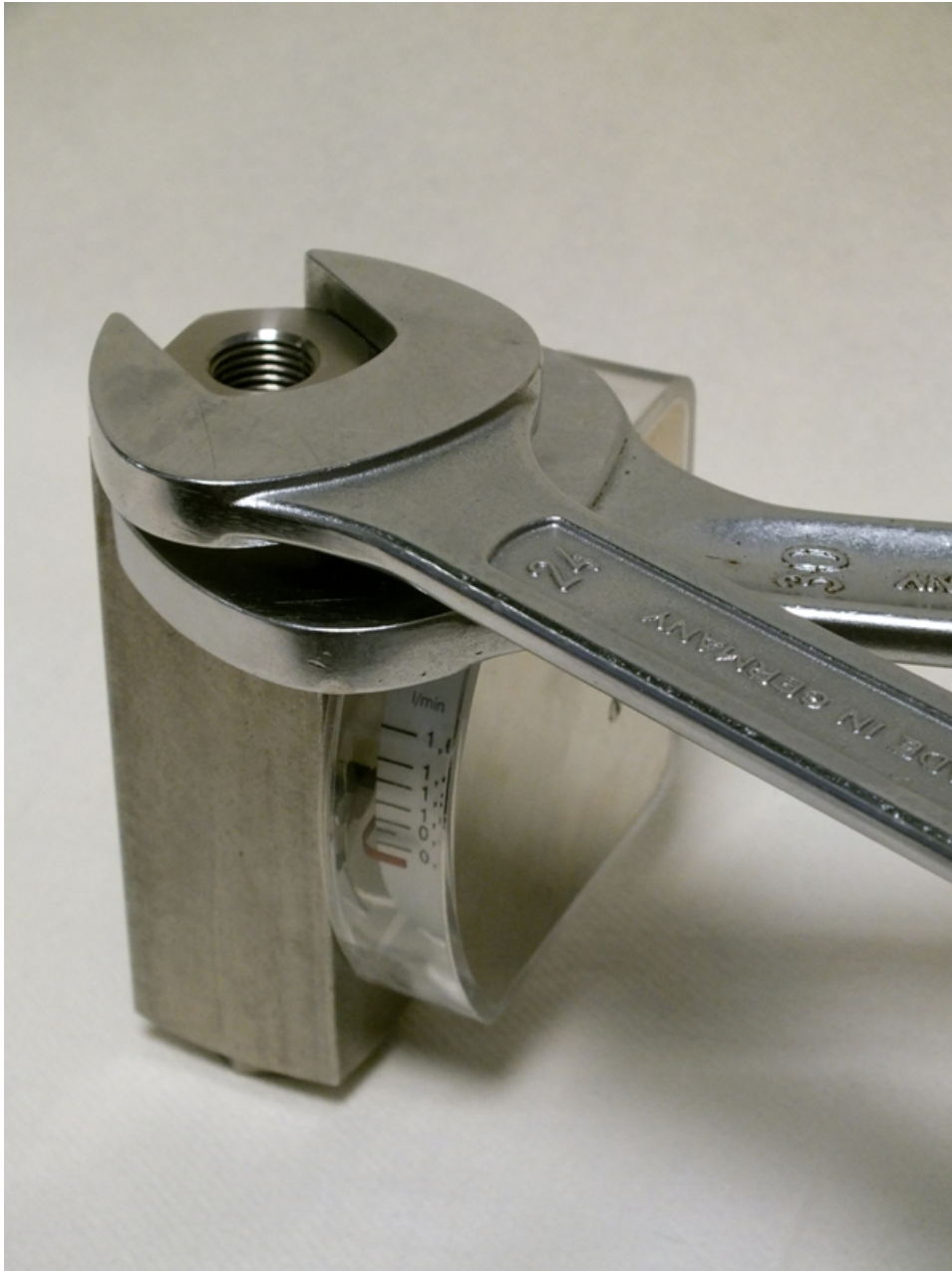
Abb. 42: Verschraubung (Ausgang) lösen
