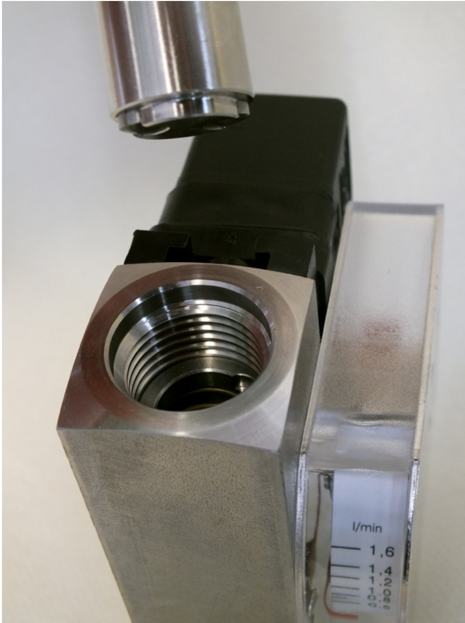
Abb. 36: Eindrehwerkzeug-Gewinding einführen (Ausgang)
