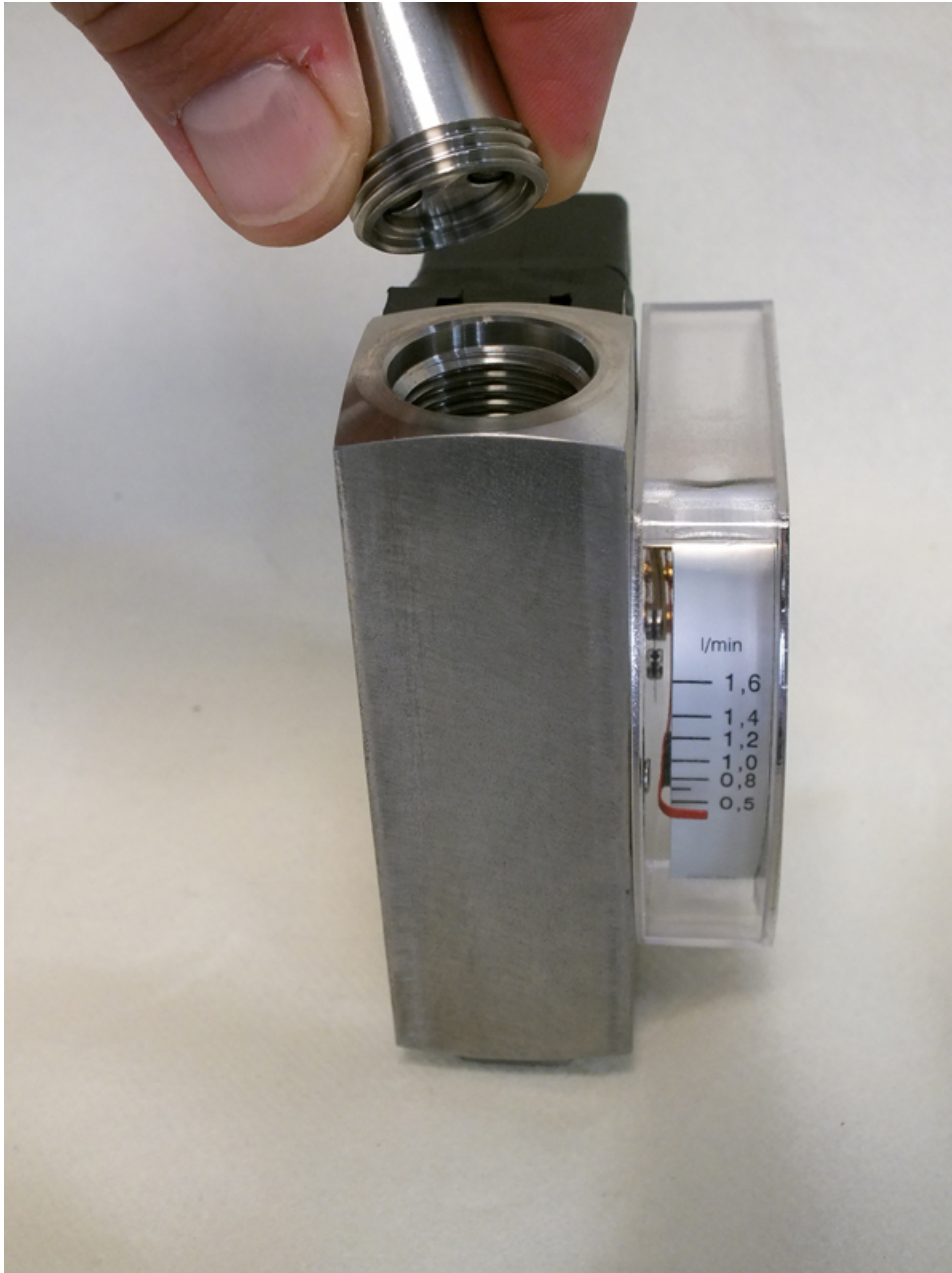
Abb. 38: Gewinding (Ausgang) entnehmen
