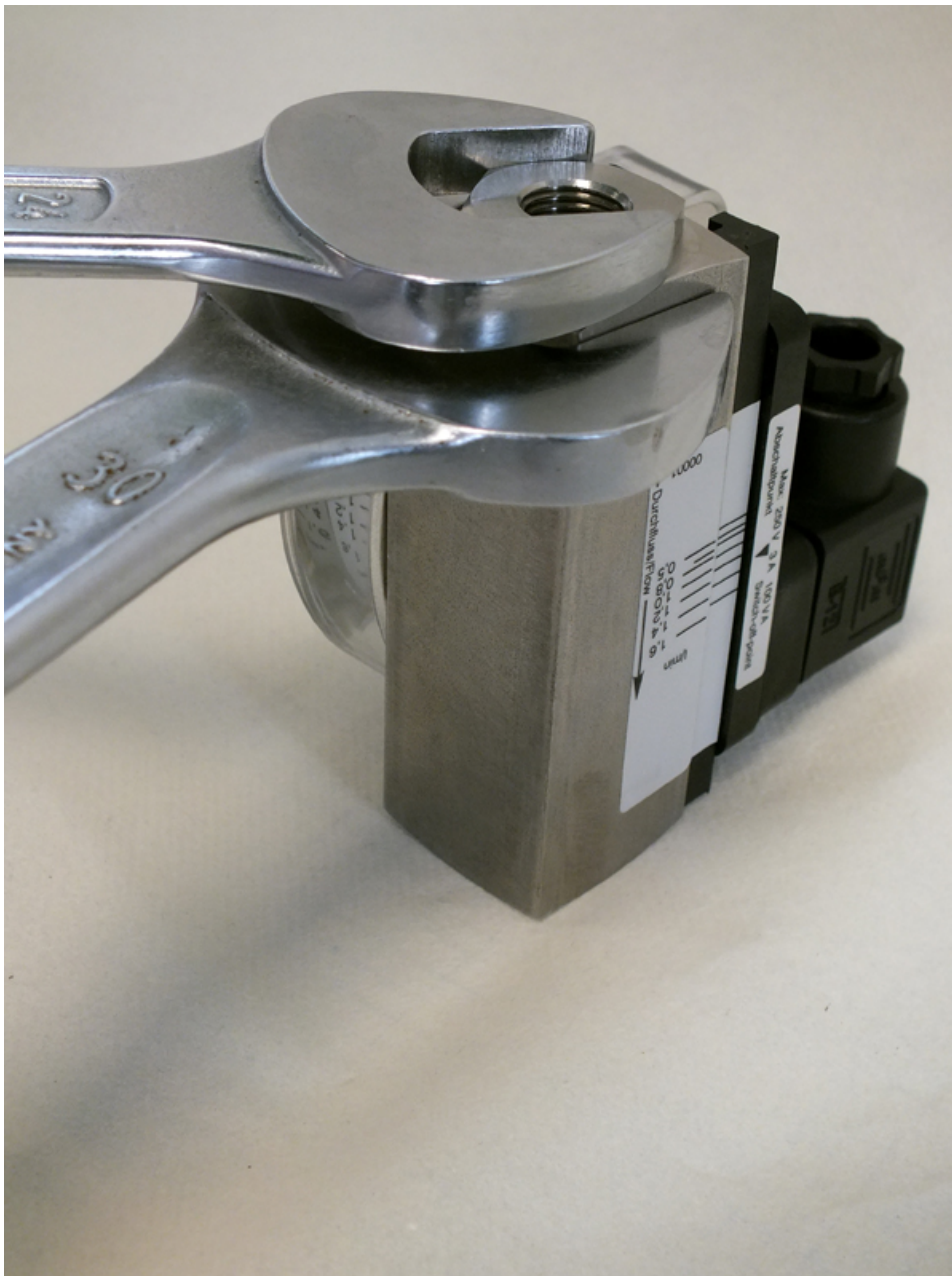
Abb. 46: Verschraubung (Eingang) festziehen
