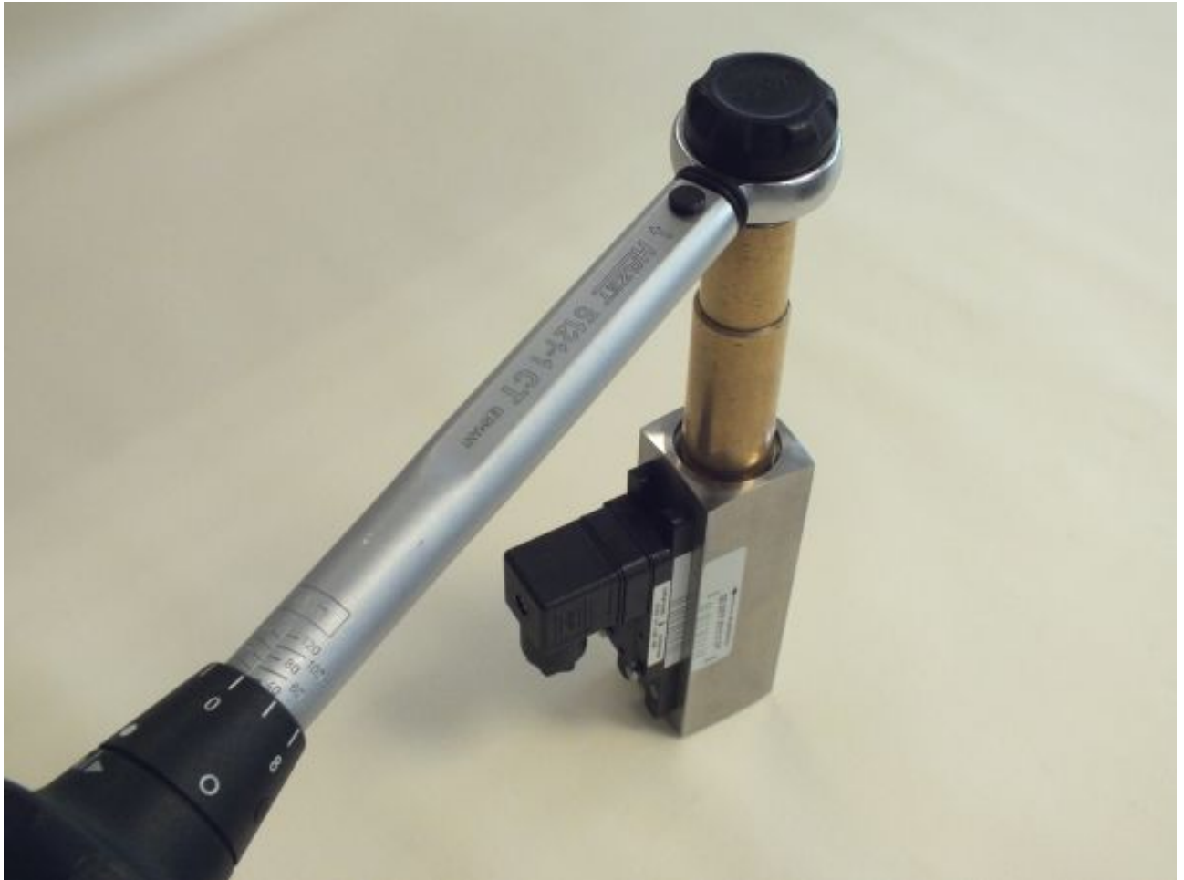
Abb. 55: Gewinding (Ausgang) festziehen
