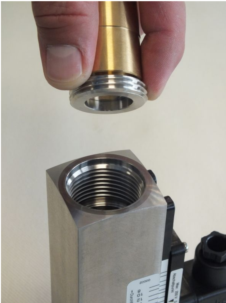
Abb. 45: Gewinding (Eingang) entnehmen
