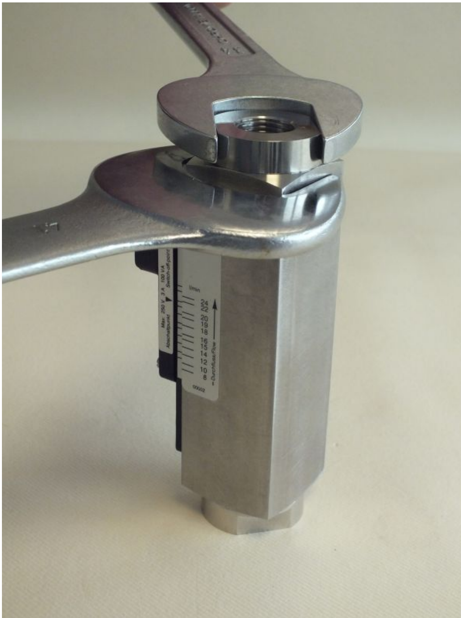
Abb. 57: Verschraubung (Ausgang) festziehen
