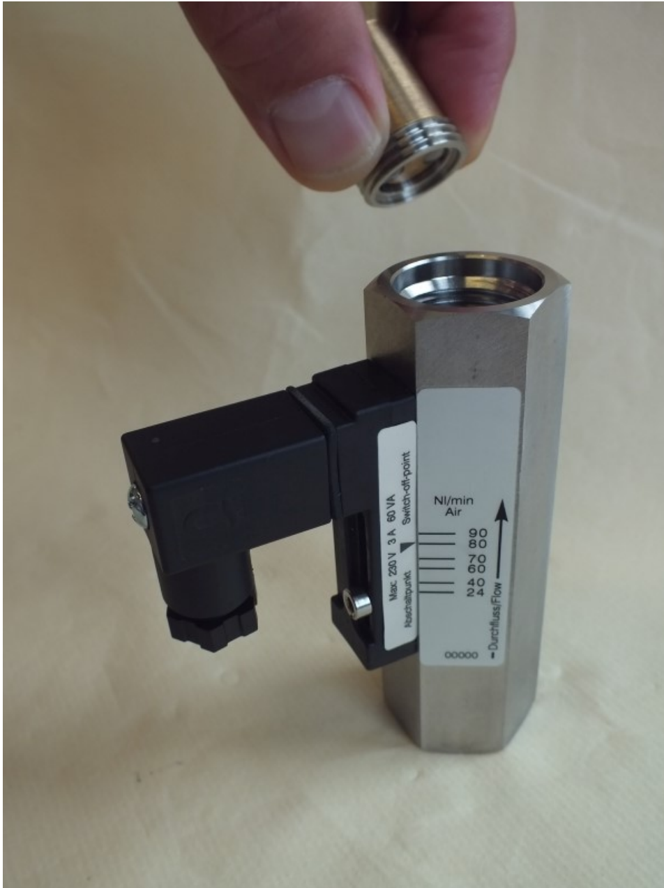
Abb. 41: Gewinding (Ausgang) einführen
