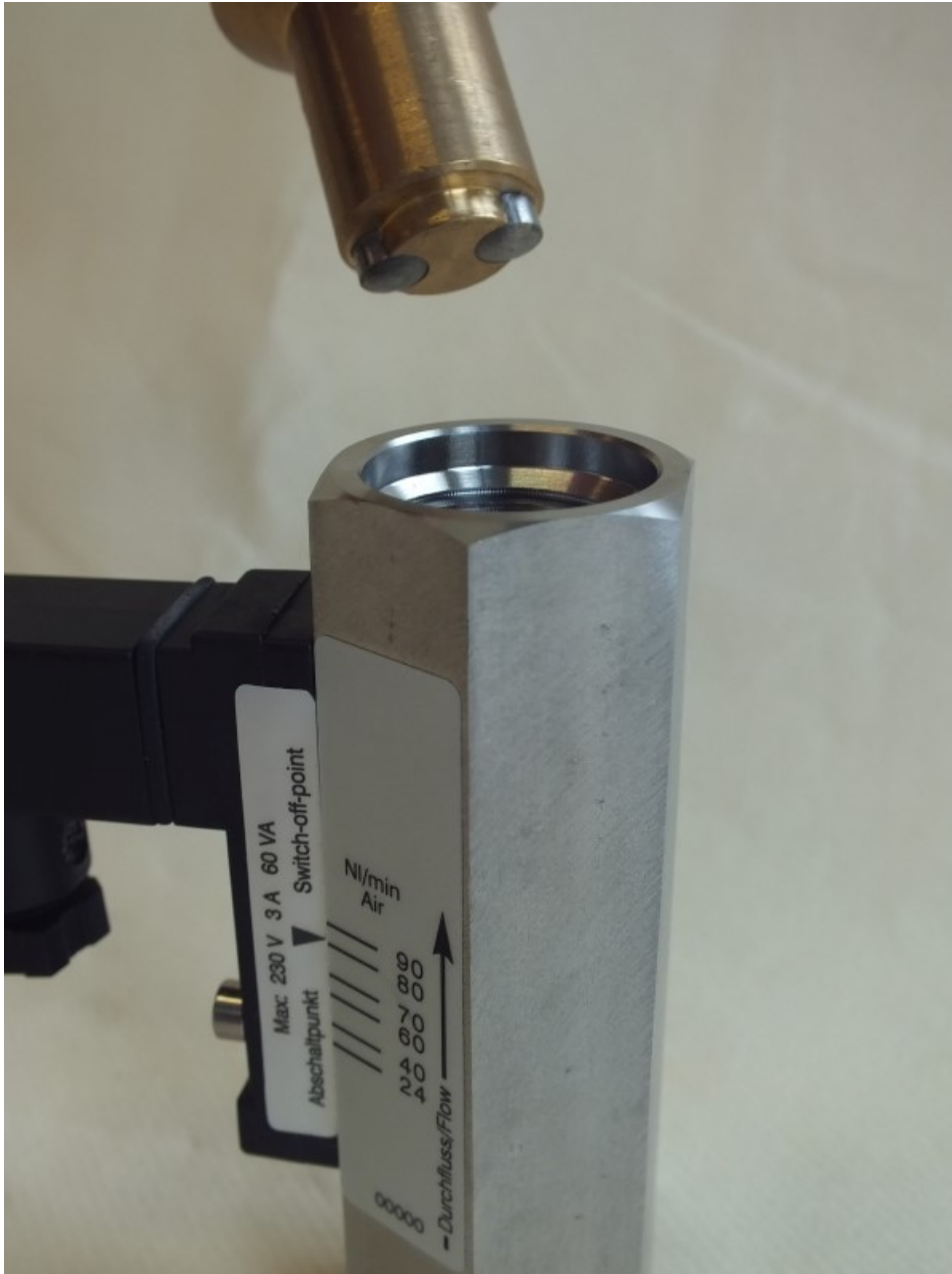
Abb. 35: Eindrehwerkzeug-Gewinding einführen (Ausgang)
