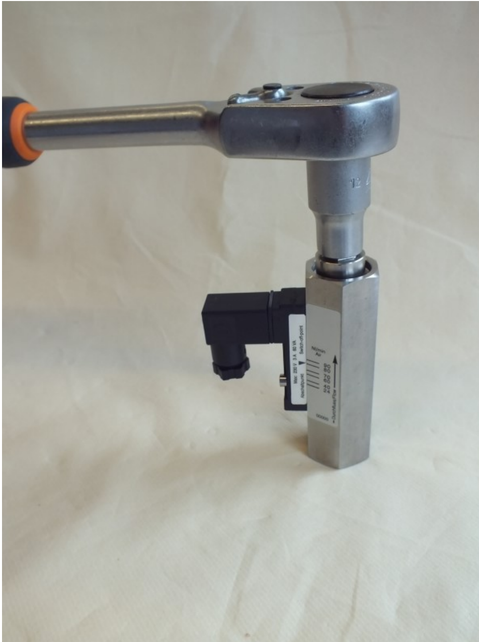
Abb. 36: Gewinding (Ausgang) lösen
