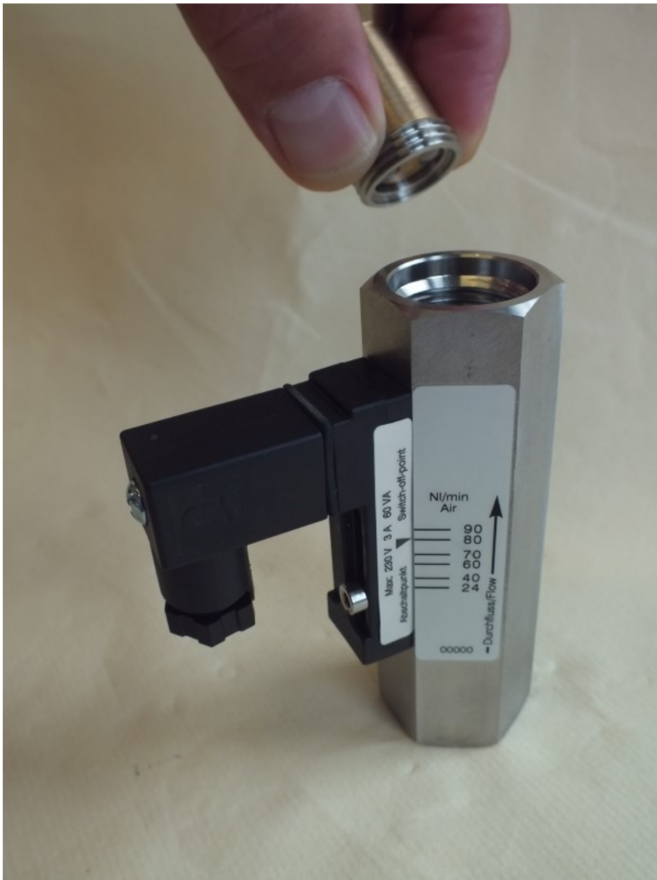
Abb. 37: Gewinding (Ausgang) entnehmen
