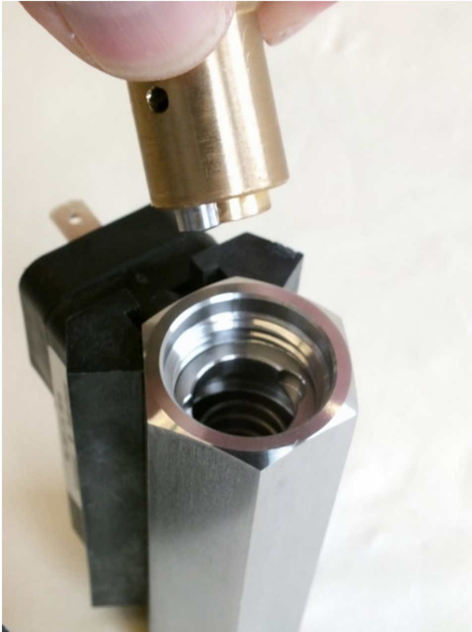
Abb. 38: Eindrückwerkzeug-Gewinding einführen (Ausgang)
