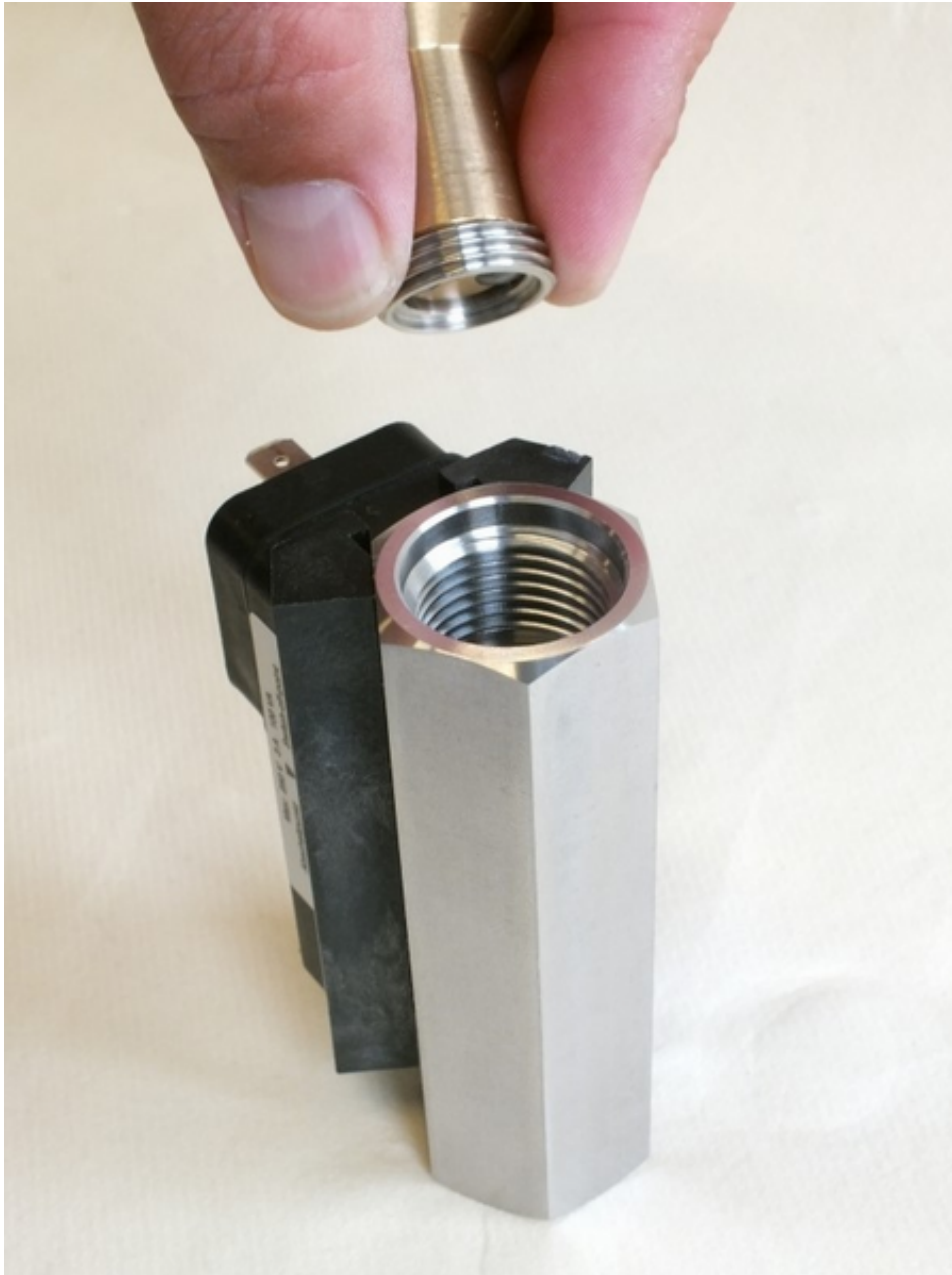
Abb. 40: Gewinding (Ausgang) entnehmen
