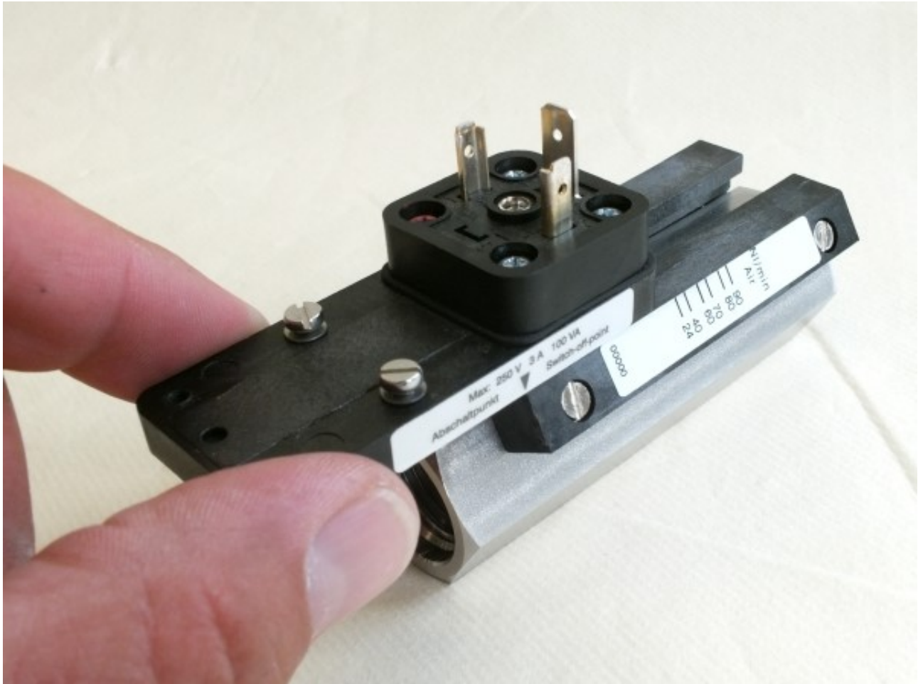
Abb. 51: Schaltkontakt aus Führung schieben
