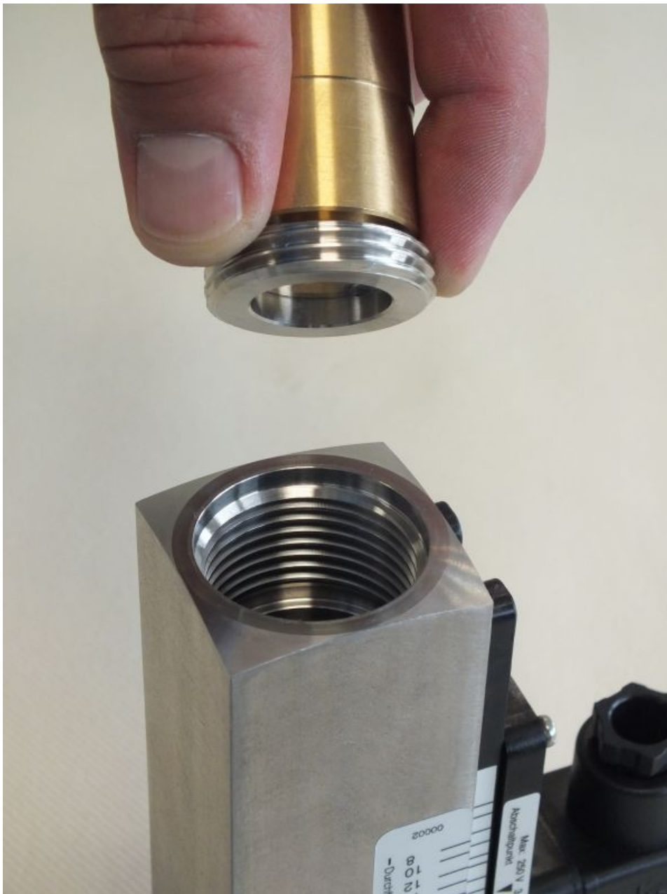
Abb. 51: Gewinding (Eingang) entnehmen
