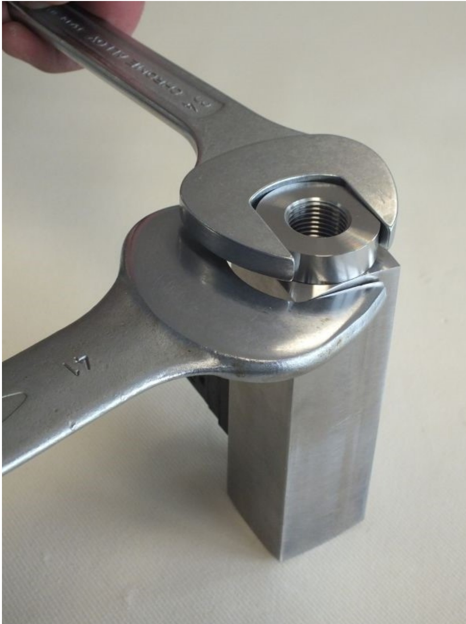
Abb. 47: Verschraubung (Eingang) lösen
