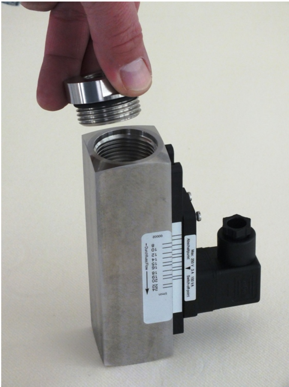
Abb. 48: Verschraubung (Eingang) abnehmen
