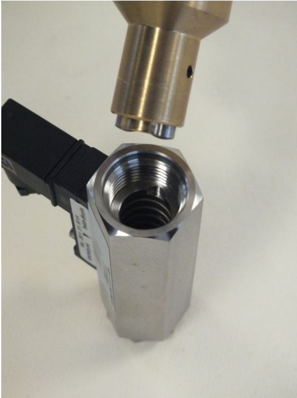
Abb. 37: Eindrehwerkzeug-Gewinding einführen (Ausgang)
