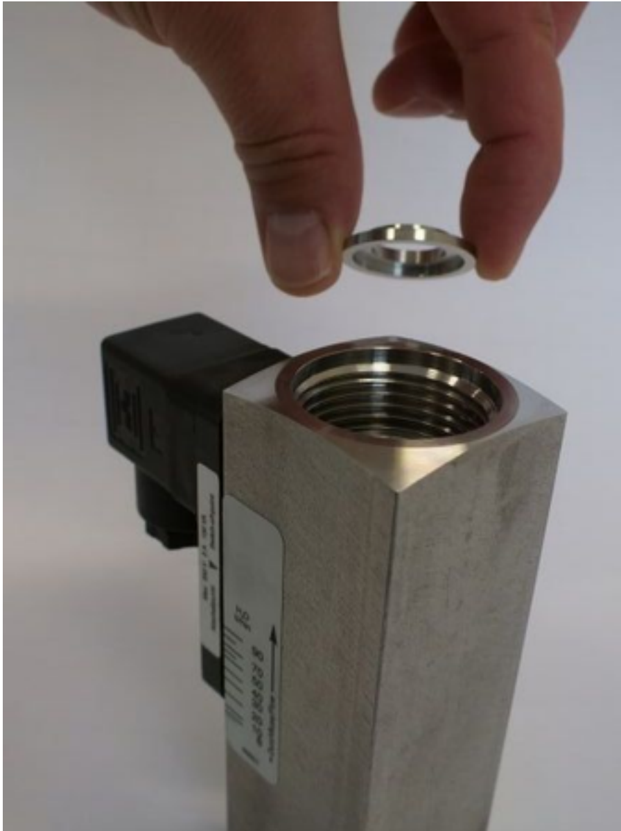
Abb. 49: Zentrierscheibe entnehmen (Ausgang)
