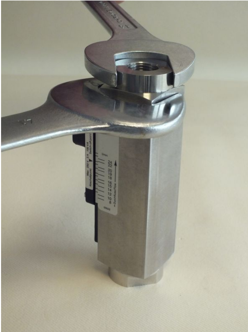
Abb. 47: Verschraubung (Ausgang) lösen
