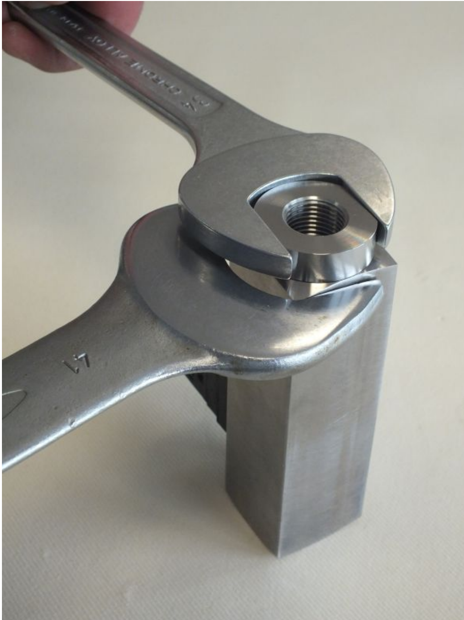
Abb. 52: Verschraubung (Eingang) lösen
