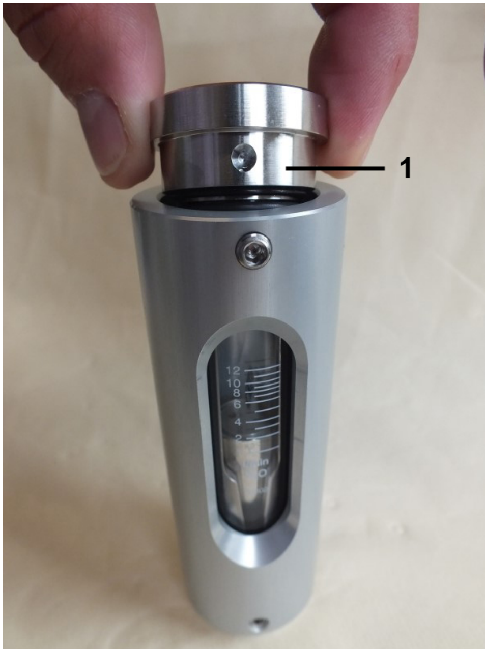
Abb. 60: Verschraubung (Ausgang) einsetzen
