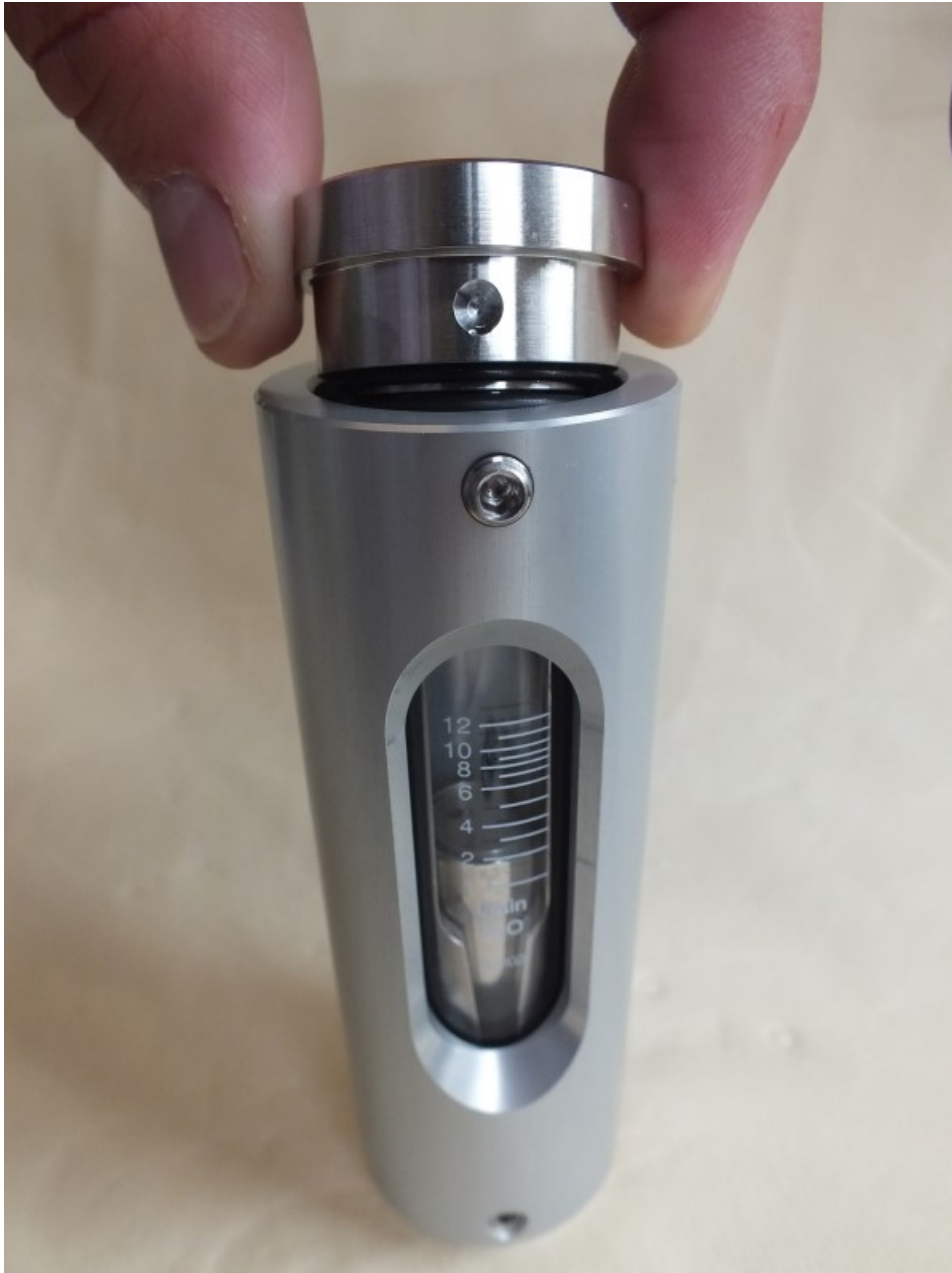
Abb. 42: Verschraubung (Ausgang) abnehmen
