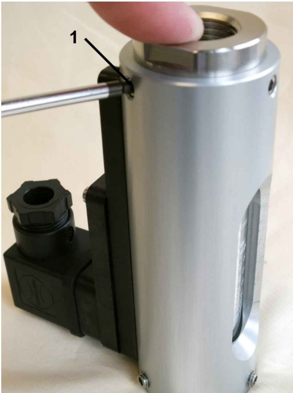
Abb. 57: Verschraubung (Eingang) befestigen
