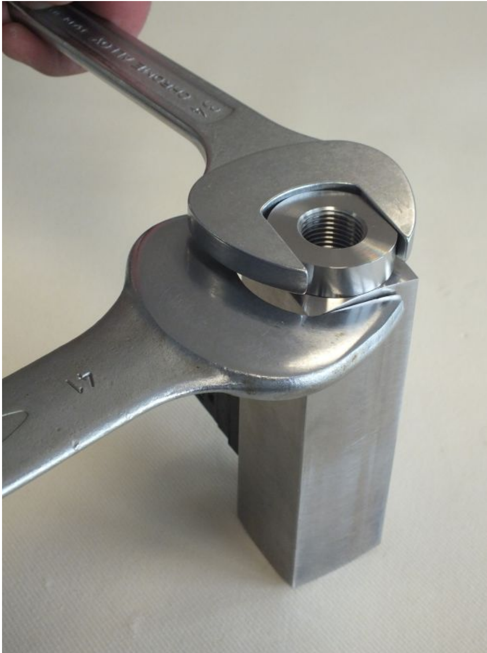
Abb. 46: Verschraubung (Eingang) lösen
