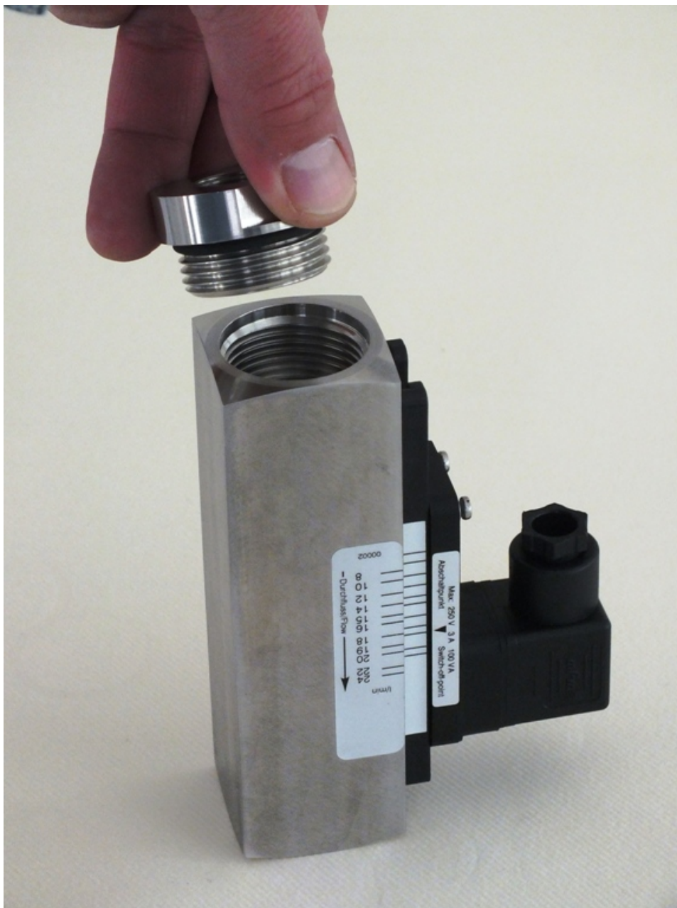
Abb. 47: Verschraubung (Eingang) abnehmen
