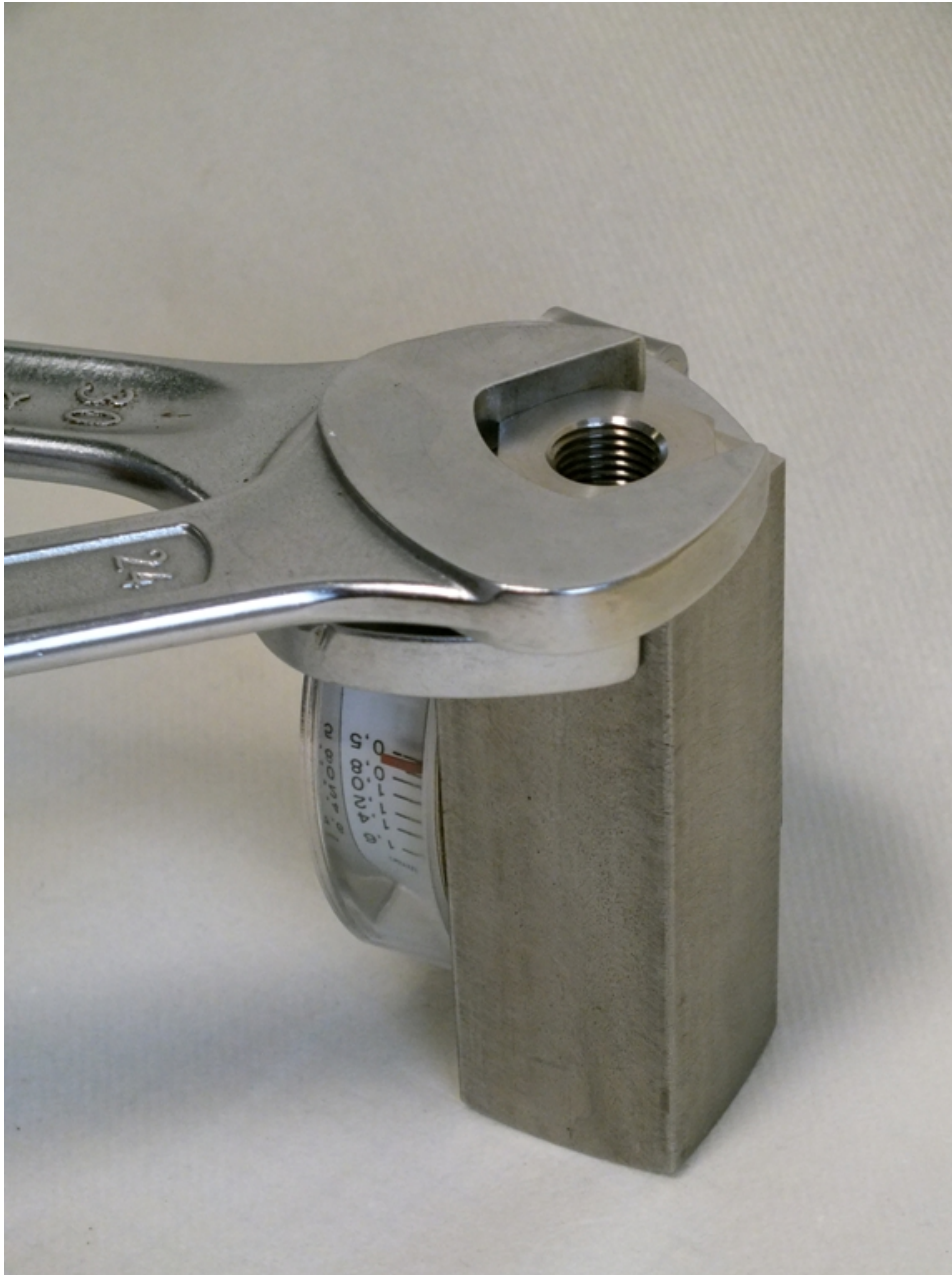
Abb. 54: Verschraubung (Eingang) festziehen
