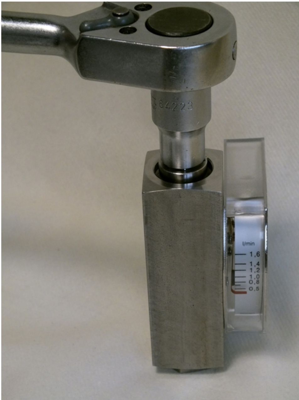
Abb. 58: Gewinding (Ausgang) festziehen
