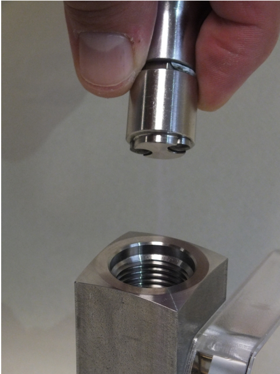
Abb. 44: Eindrehwerkzeug-Gewinding einführen (Ausgang)
