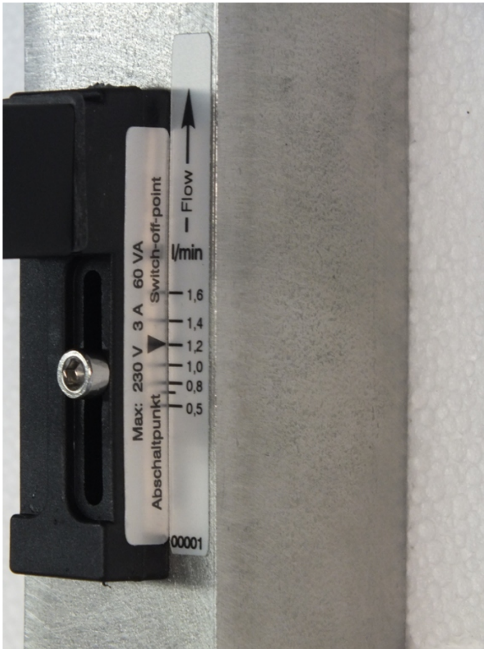
Abb. 35: Schaltwert ablesen (Beispielskala)
