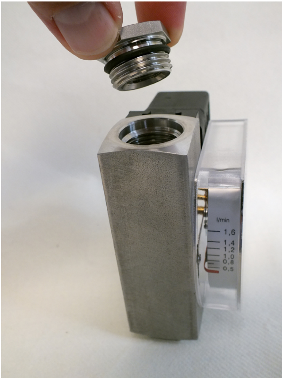
Abb. 63: Verschraubung (Ausgang) einsetzen
