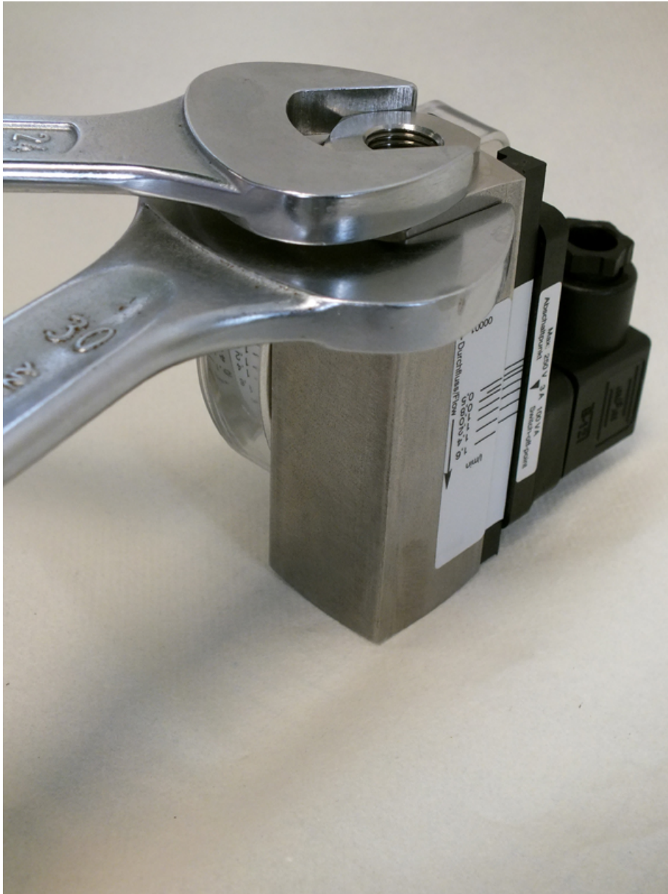
Abb. 53: Verschraubung (Eingang) lösen
