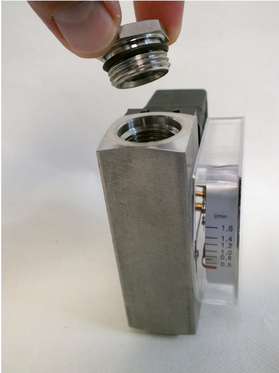
Abb. 47: Verschraubung (Ausgang) abnehmen
