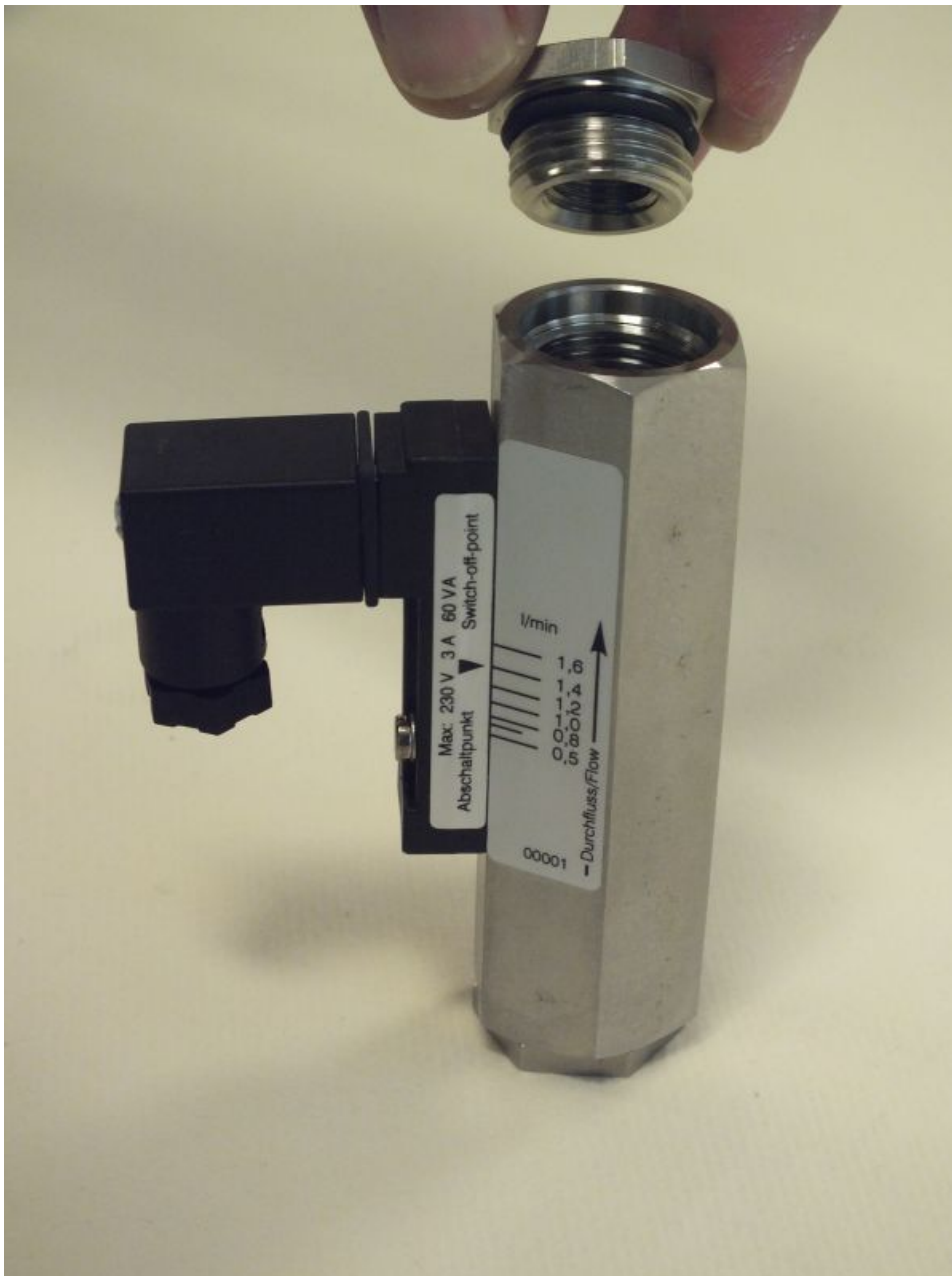
Abb. 52: Verschraubung (Ausgang) einsetzen
