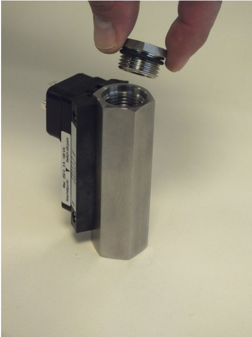
Abb. 56: Verschraubung (Ausgang) einsetzen
