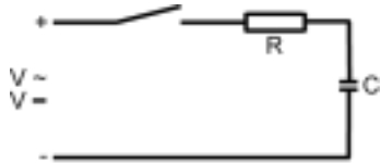
Abb. 33: Schutzmaßnahme bei kapazitiver Belastung
