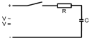
Abb. 35: Schutzmaßnahme bei kapazitiver Belastung
