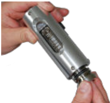
Abb. 57: Verschraubung in Gerätehülse schieben
