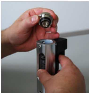
Abb. 42: Verschraubung (Ausgang) abnehmen
