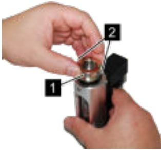
Abb. 61: Verschraubung (Ausgang) einsetzen
