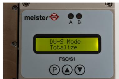
Bei einer Unterbrechung der Stromversorgung vom FSQ/S1 bleibt der Totalisator erhalten. Unter der Funktion "Bat Check" können die Stromausfälle angezeigt werden.
