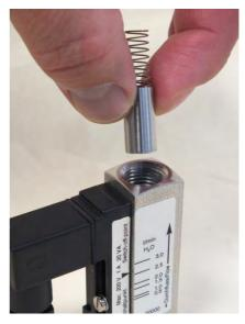
Fig. 46: Insert inner parts
