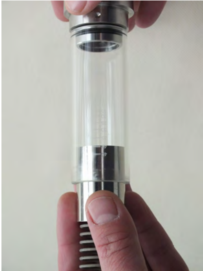
Abb. 40: Schwebekörper, Magnete und Feder entnehmen
