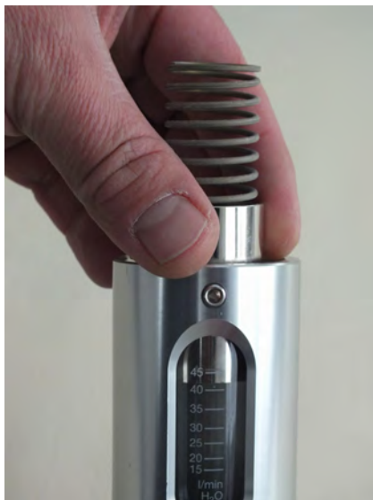
Abb. 50: Schwebekörper und Innenteile einführen
