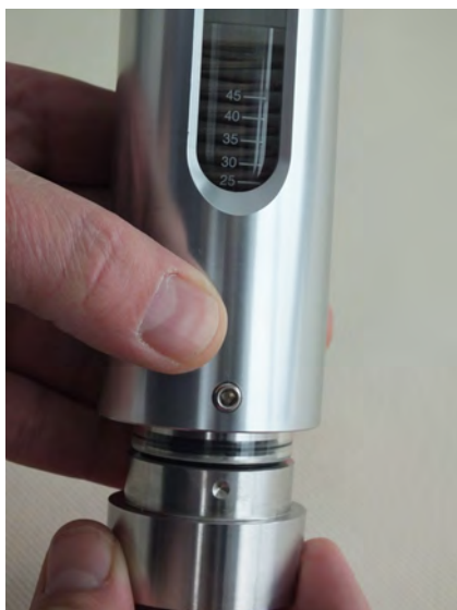
Abb. 47: Verschraubung in Gerätehülse schieben
