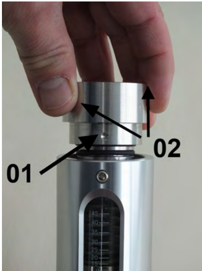
Abb. 51: Verschraubung (Ausgang) in Gerätehülse einsetzen
