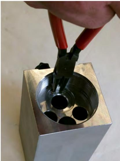
*Abb. 36: Innensicherungsring (Eingang) lösen*
