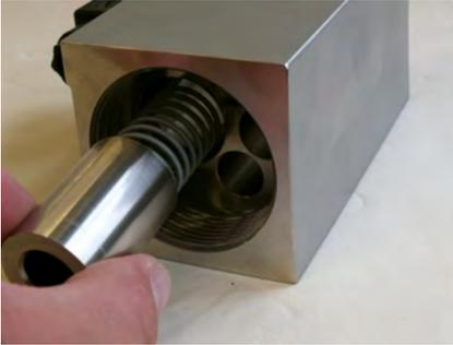
Abb. 38: Innenteile entnehmen
