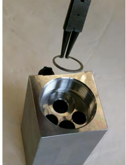
Abb. 42: Innensicherungsring (Eingang) einführen
