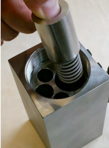
Abb. 41: Innenteile einführen
