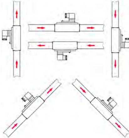
Abb. 5: Einbauposition/Durchflussrichtung
