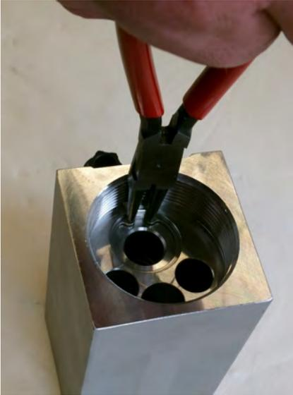
Abb. 43: Innensicherungsring in Sicherungsringnut einsetzen
