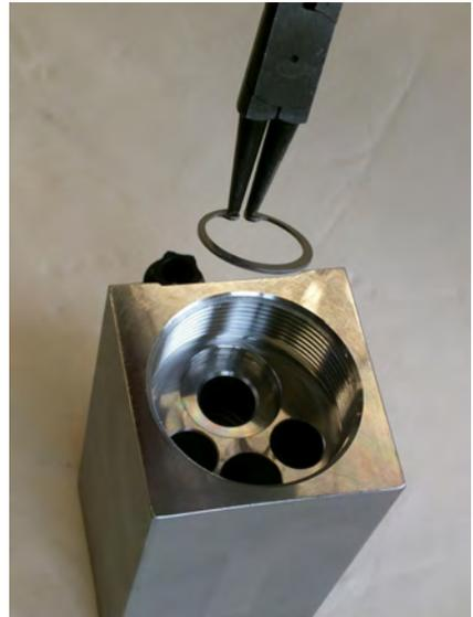
*Abb. 37: Innensicherungsring entnehmen*
