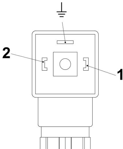
Abb. 14: Pin-Belegung Steckerdose Schließer (Erde-Anschluss nicht genutzt)
