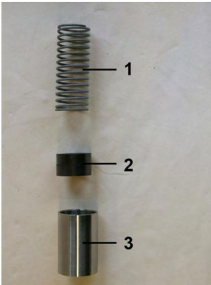
Abb. 39: Feder, Magnete und Schwebekörper
