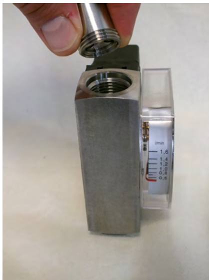
Abb. 47: Gewinding (Ausgang) entnehmen
