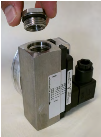
Abb. 54: Verschraubung (Eingang) einsetzen
