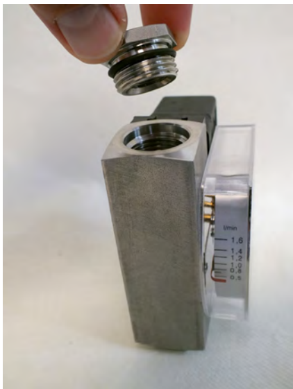
Abb. 60: Verschraubung (Ausgang) einsetzen
