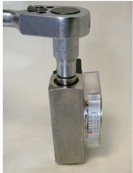
Abb. 59: Gewinding (Ausgang) festziehen
