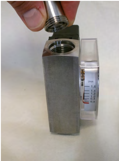
Abb. 58: Gewinding (Ausgang) einführen
