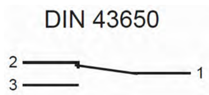
Abb. 16: Zustand des Kontaktes bei Gerät ohne Durchfluss
