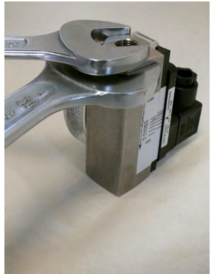
Abb. 55: Verschraubung (Eingang) festziehen
