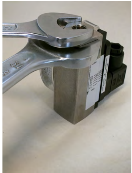
Abb. 50: Verschraubung (Eingang) lösen
