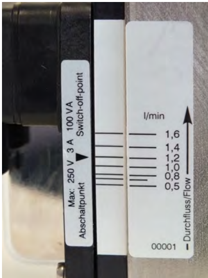
Abb. 36: Schaltwert ablesen (Beispiel-skala)
