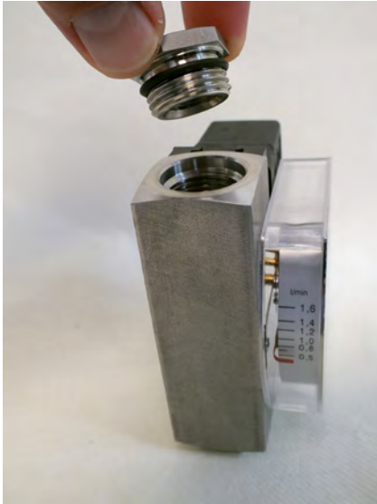
Abb. 44: Verschraubung (Ausgang) abnehmen
