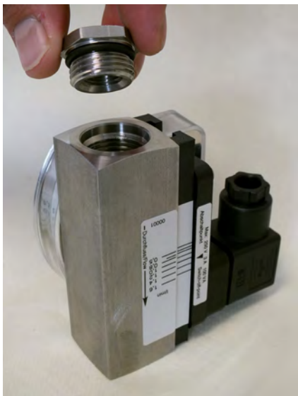
Abb. 51: Verschraubung (Eingang) abnehmen
