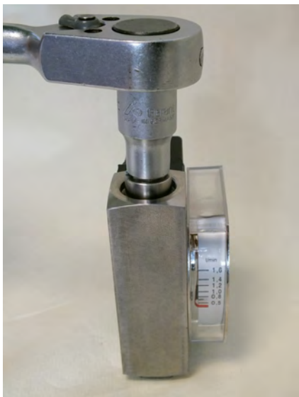
Abb. 46: Gewinding (Ausgang) lösen
