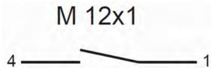
Abb. 19: Zustand des Kontakts bei Gerät ohne Durchfluss
