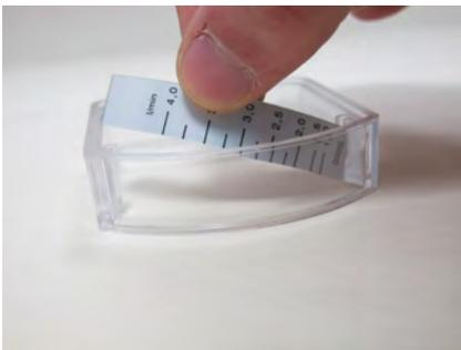
Abb. 41: Skalenträger aus Führung ziehen
