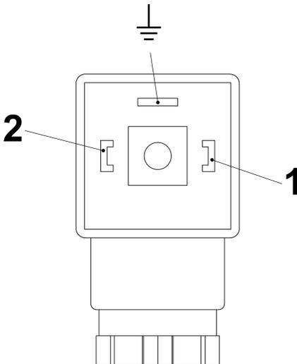
Abb. 15: Pin-Belegung Steckerdose Schließer (Erde-Anschluss nicht genutzt)
