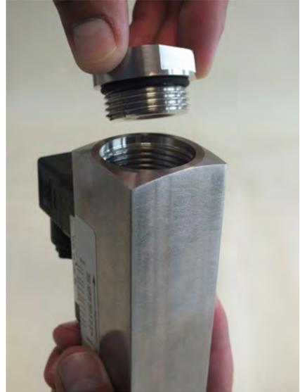
Abb. 44: Verschraubung (Ausgang) abnehmen
