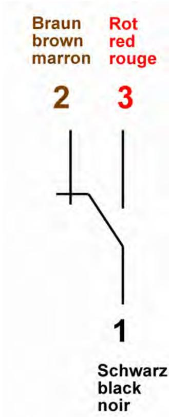
Abb. 22: Zustand des Kontakts bei Gerät ohne Durchfluss
