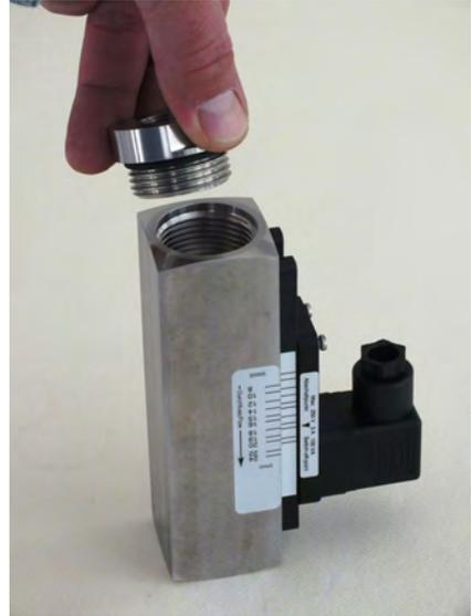
Abb. 49: Verschraubung (Eingang) abnehmen
