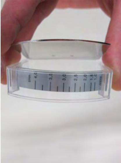
Abb. 40: Anzeige-Deckelplatte herausdrücken
