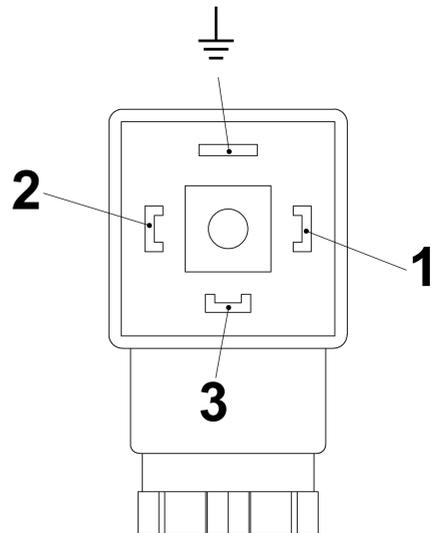
Abb. 17: Pin-Belegung Steckerdose Wechsler (Erde-Anschluss nicht genutzt)
