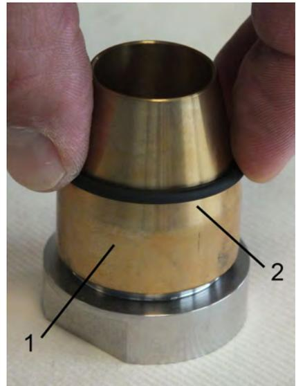
Abb. 50: O-Ring (Dichtung)
