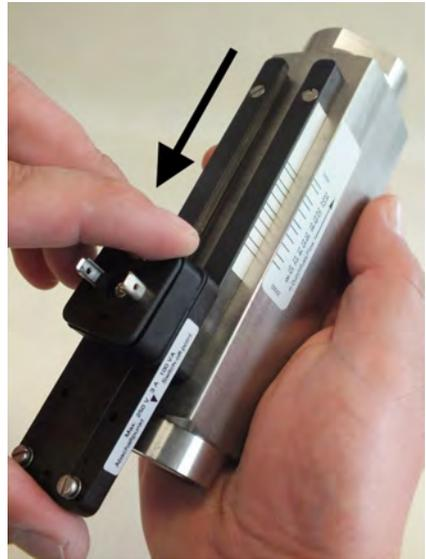
Abb. 68: Schaltkontakt aus Führung schieben
