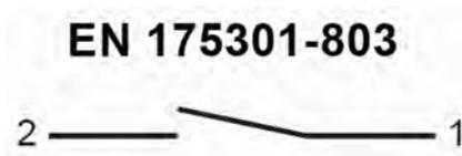
Abb. 14: Zustand des Kontakts bei Gerät ohne Durchfluss
