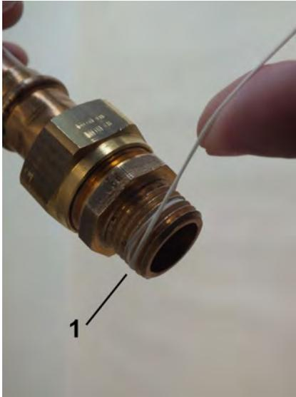
Abb. 10: Dichtfaden aufbringen
