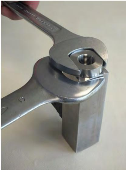
Abb. 53: Verschraubung (Eingang) festziehen
