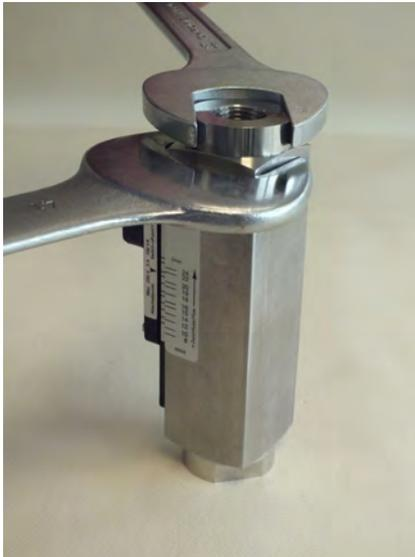
Abb. 58: Verschraubung (Ausgang) festziehen
