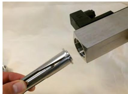
Abb. 55: Innenteile einführen
