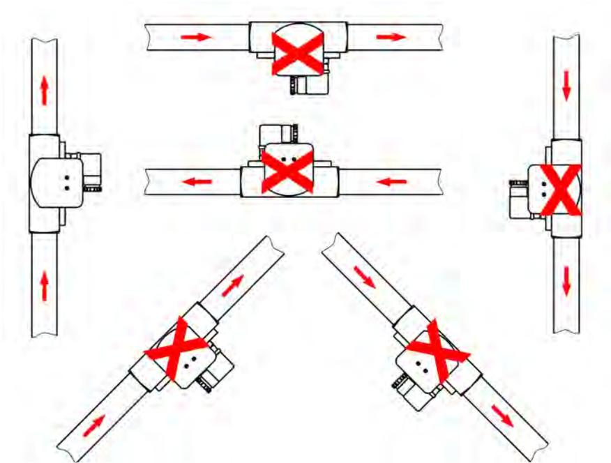
Abb. 6: Einbauposition/Durchflussrichtung
