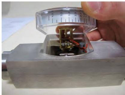
Abb. 39: Anzeige-Deckelplatte mit Gehäuse abheben
