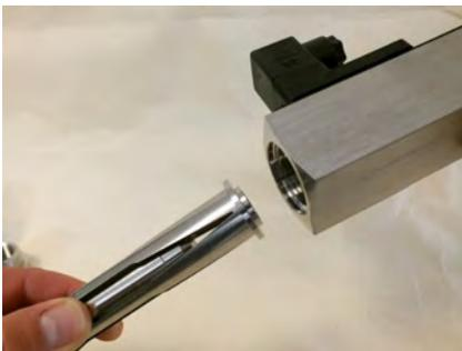
Abb. 46: Innenteile entnehmen
