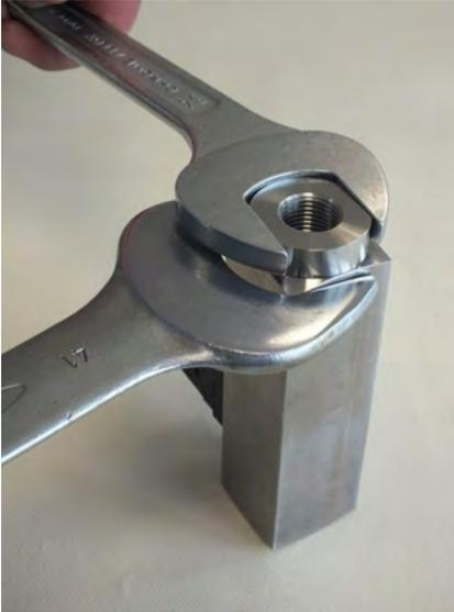
Abb. 48: Verschraubung (Eingang) lösen
