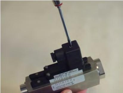
Abb. 22: Steckerdose lösen
