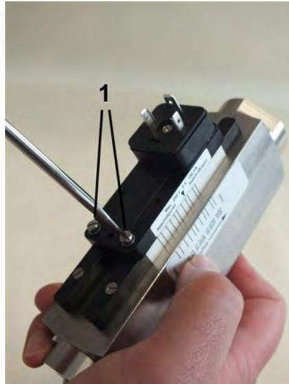
Abb. 55: Feststellschrauben lösen
