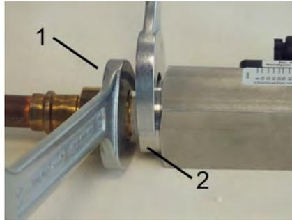
Abb. 12: Gerät einschrauben
