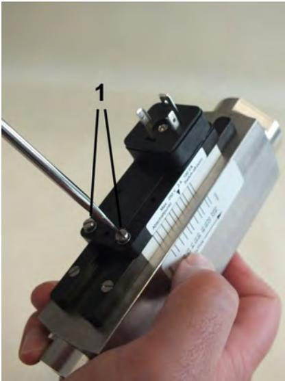
Abb. 34: Feststellschrauben lösen
