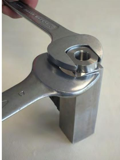
Abb. 46: Verschraubung (Eingang) festziehen
