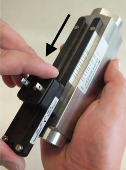
Abb. 56: Schaltkontakt aus Führung schieben
