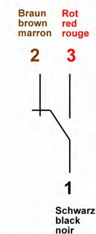
Abb. 21: Zustand des Kontakts bei Gerät ohne Durchfluss
