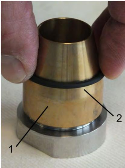
Abb. 43: O-Ring (Dichtung)
