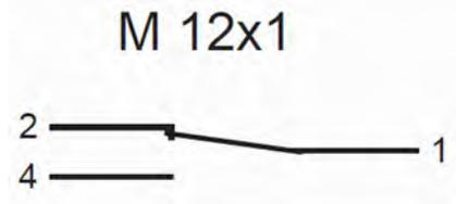
Abb. 19: Zustand des Kontakts bei Gerät ohne Durchfluss
