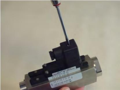
Abb. 53: Steckerdose lösen
