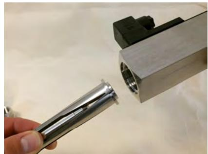
Abb. 39: Innenteile entnehmen
