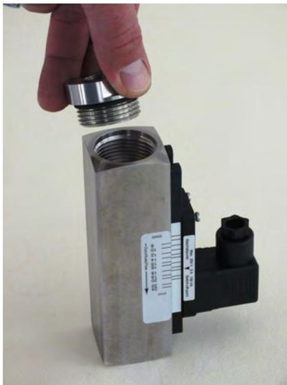
Abb. 42: Verschraubung (Eingang) abnehmen
