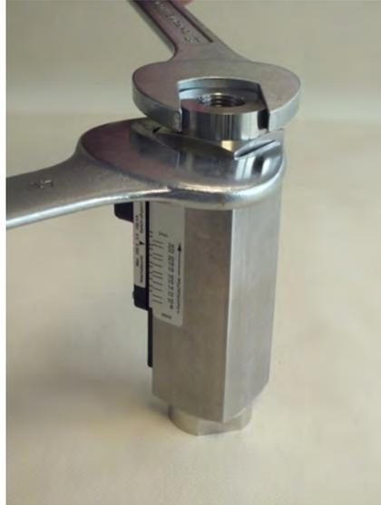
*Abb. 51: Verschraubung (Ausgang) festziehen*
