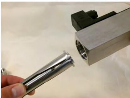
Abb. 48: Innenteile einführen
