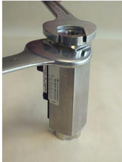
*Abb. 36: Verschraubung (Ausgang) lösen*
