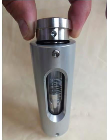
Abb. 37: Verschraubung (Ausgang) abnehmen
