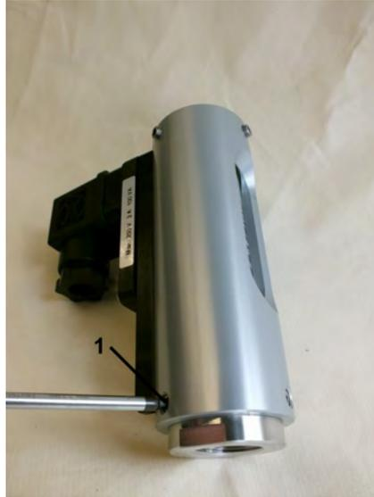
Abb. 39: Schrauben lösen
