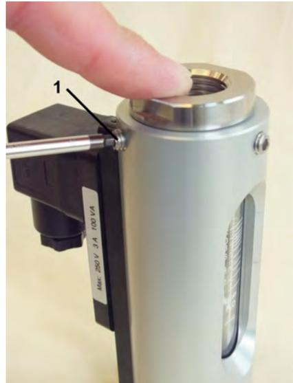
Abb. 56: Innensechskantschrauben anziehen
