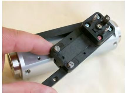
Abb. 62: Führungsleiste wegklappen
