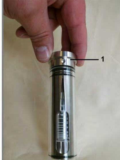
Abb. 49: Verschraubung (Eingang)
