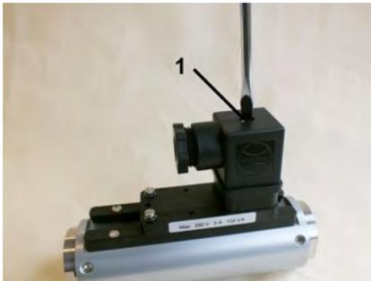
Abb. 22: Steckdose lösen
