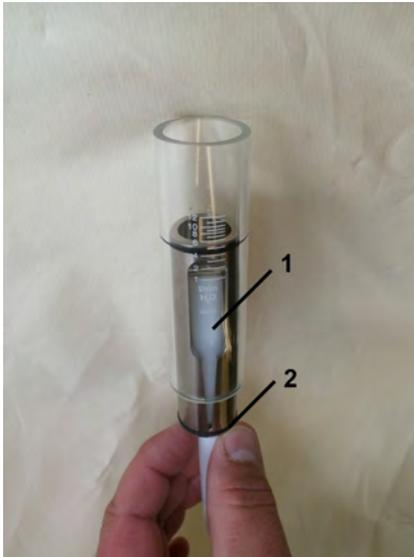
Abb. 46: Schlitzdüse durchschieben
