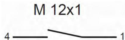
Abb. 18: Zustand des Kontakts bei Gerät ohne Durchfluss
