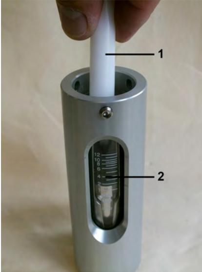
Abb. 53: Schlitzdüse ausrichten
