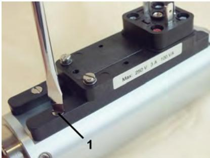
Abb. 61: Führungsleiste lösen
