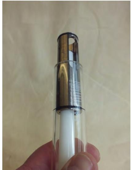
Abb. 41: Schlitzdüse entnehmen
