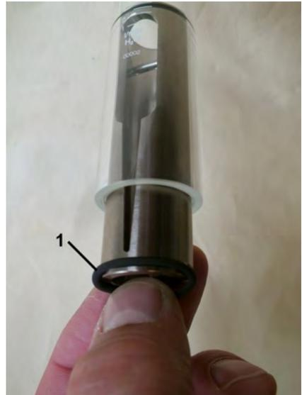
Abb. 47: Schlitzdüsenzentrierung
