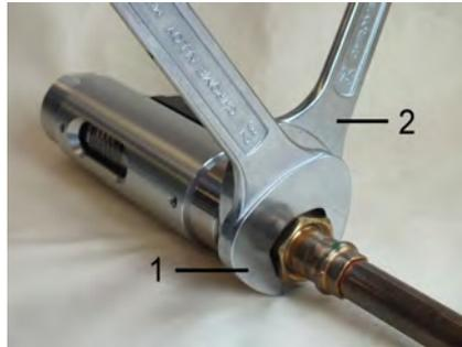
Abb. 12: Gerät einschrauben
