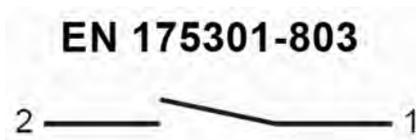
Abb. 13: Zustand des Kontakts bei Gerät ohne Durchfluss
