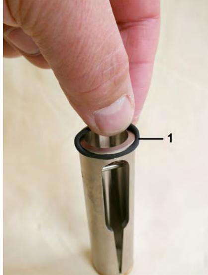
Abb. 45: O-Ring (Schlitzdüsenzentrierung)
