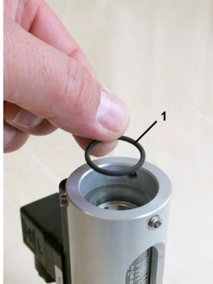
Abb. 54: O-Ring Schlitzdüsenpuffer
