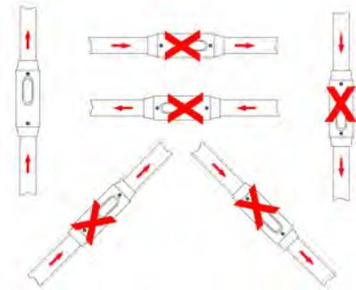
Abb. 5: Einbauposition/Durchflussrichtung
