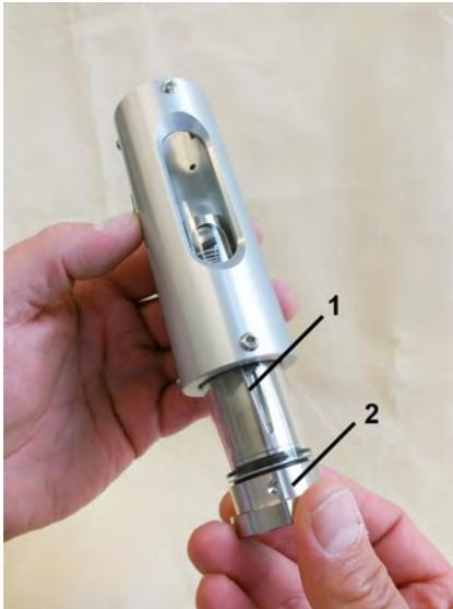
Abb. 40: Innenteile herausziehen
