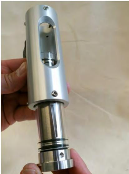
Abb. 51: Verschraubung in Gerätehülse schieben
