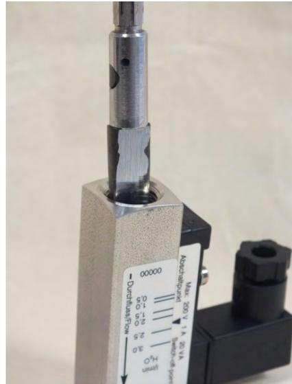
Abb. 41: Gewindering (Eingang) lösen
