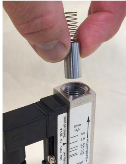
Abb. 46: Innenteile einführen
