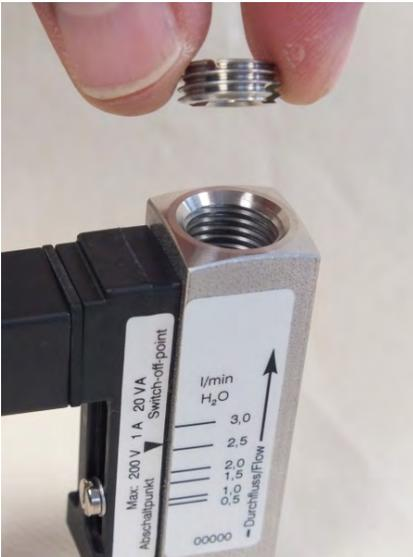
Abb. 47: Gewinding (Ausgang) einführen
