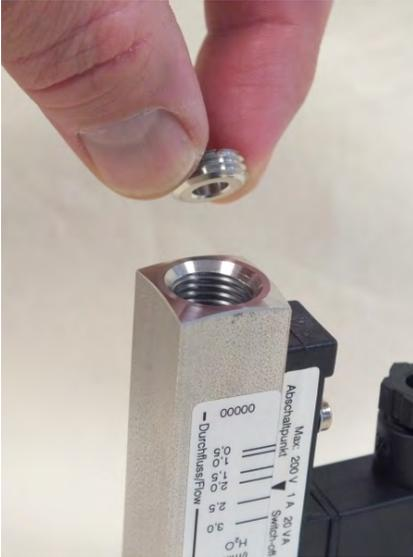
Abb. 42: Gewinding (Eingang) entnehmen
