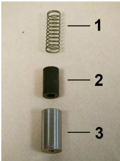
Abb. 39: Feder, Magnete und Schwebekörper
