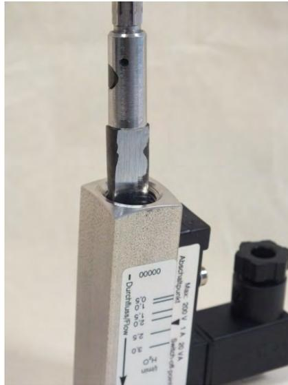
Abb. 44: Gewinding (Eingang) festziehen
