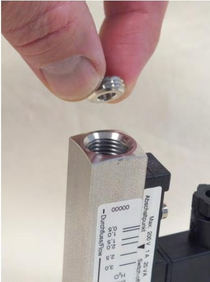
Abb. 43: Gewinding (Eingang) einführen
