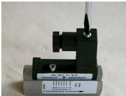
Abb. 50: Steckerdose lösen
