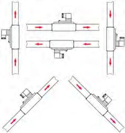
Abb. 5: Einbauposition/Durchflussrichtung
