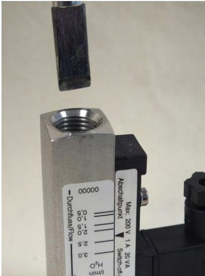
Abb. 40: Eindrehwerkzeug Gewindering (Eingang) einführen
