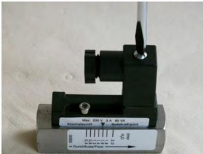
Abb. 21: Steckerdose lösen
