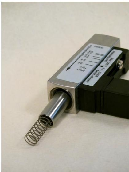
Abb. 38: Innenteile entnehmen
