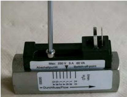
Abb. 52: Feststellschraube Schaltkontakt lösen
