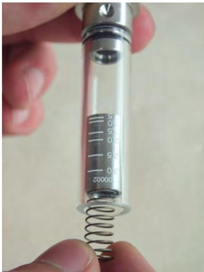
Abb. 39: Schwebekörper, Magnete und Feder entnehmen
