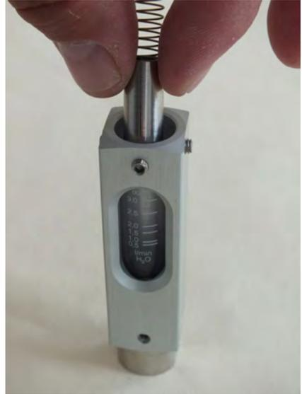
Abb. 49: Schwebekörper und Innenteile einführen
