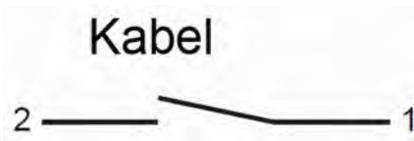
Abb. 20: Zustand des Kontaktes bei Gerät ohne Durchfluss
