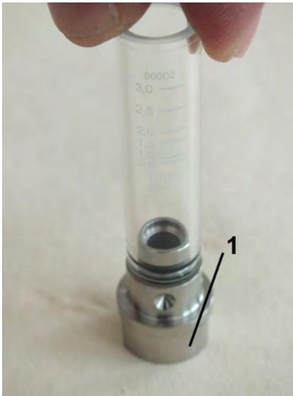
Abb. 44: Verschraubung (Eingang) in Schauglas
