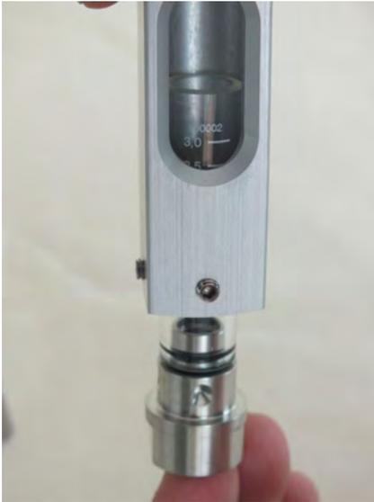
Abb. 46: Verschraubung in Geräte­hülse schieben
