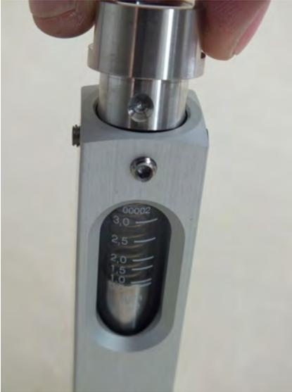
Abb. 50: Verschraubung (Ausgang) in Gerätehülse einsetzen
