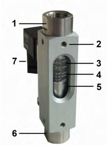
In dem Strömungswächter befindet sich ein Schwebekörper, der durch das durchfließende Medium bewegt wird. Durch die im Schwebekörper integrierten Magnete wird ein Magnetfeld erzeugt. Die Position des Schwebekörpers wird durch den Schaltkontakt ermittelt. Neben der elektrischen Kontrolle durch den Reed-Kontakt (Schaltkontakt) kann der aktuelle Durchfluss auch an der Messskala des Schauglases abgelesen werden.
