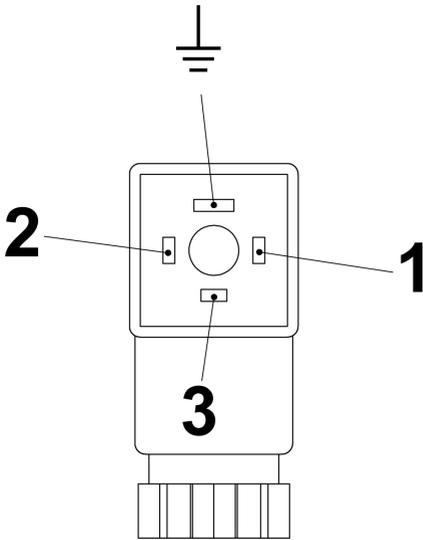
Abb. 16: Pin-Belegung Steckerdose Wechsler (Erde-Anschluss nicht genutzt)
