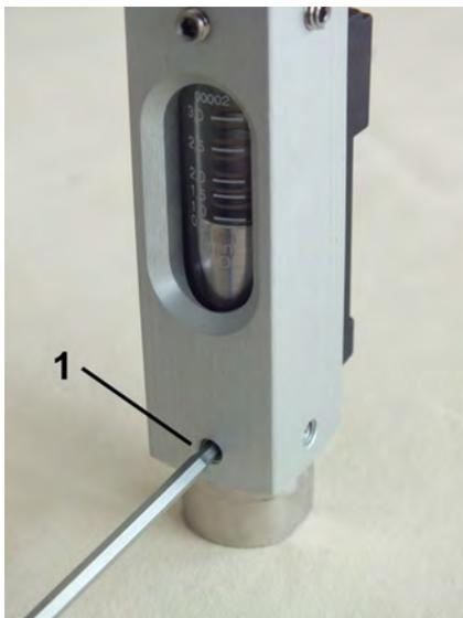
Abb. 37: Schrauben lösen
