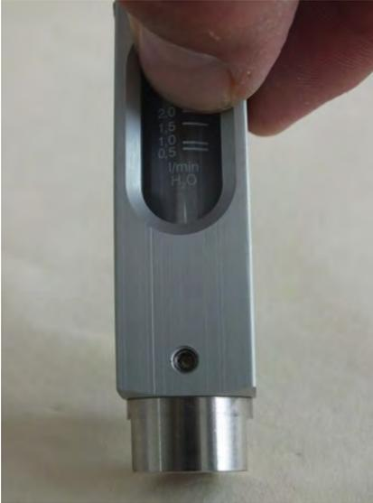
Abb. 48: Schauglas ausrichten
