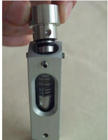
Abb. 36: Verschraubung (Ausgang) abnehmen
