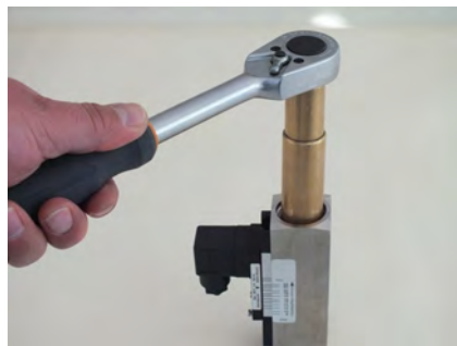
Abb. 46: Gewinding (Ausgang) lösen
