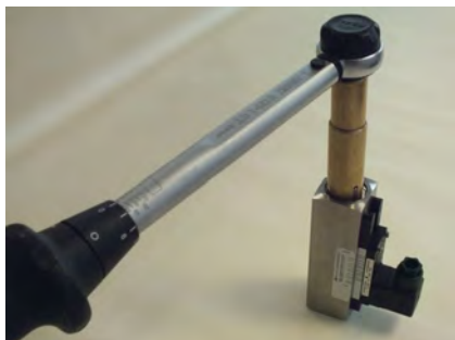
Abb. 58: Gewinding (Eingang) festziehen
