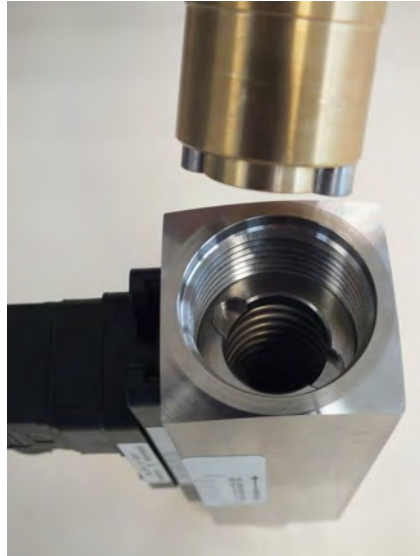
Abb. 45: Eindrehwerkzeug-Gewinding einführen (Ausgang)
