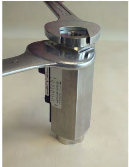
Abb. 43: Verschraubung (Ausgang) lösen
