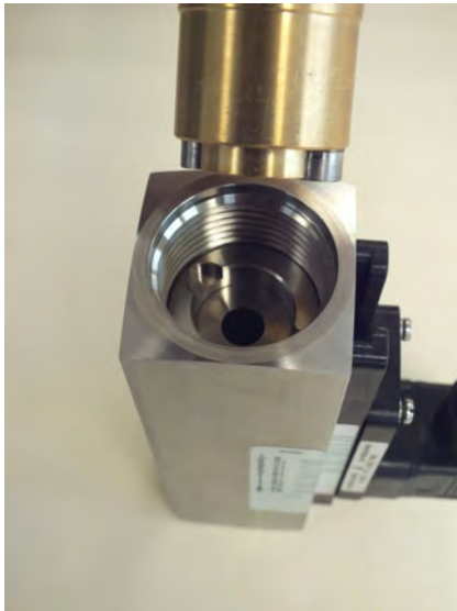
Abb. 52: Eindrehwerkzeug Gewindering (Eingang) einführen
