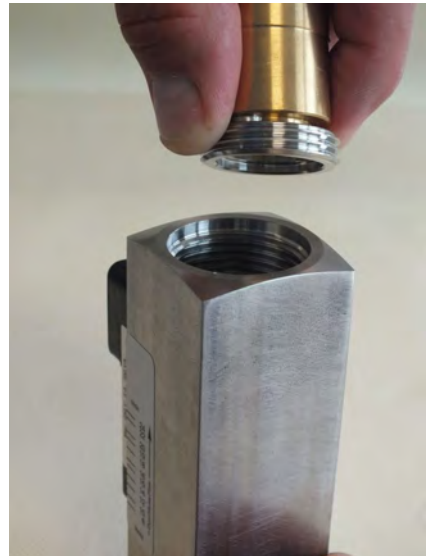
Abb. 63: Gewinding (Ausgang) einführen
