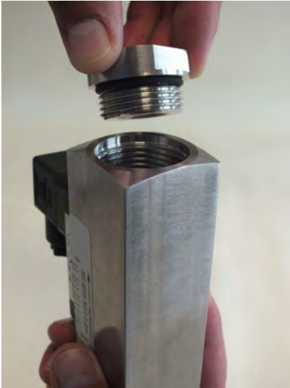
Abb. 65: Verschraubung (Ausgang) einsetzen
