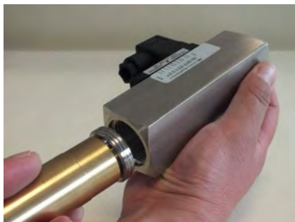
Abb. 57: Gewinding (Eingang) einführen
