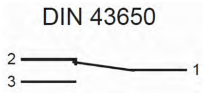
Abb. 15: Zustand des Kontaktes bei Gerät ohne Durchfluss
