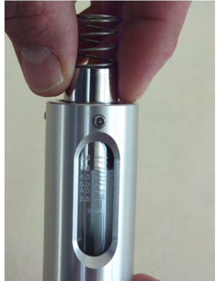
Abb. 49: Schwebekörper und Innenteile einführen
