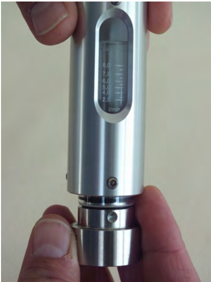
Abb. 46: Verschraubung in Gerätehülse schieben
