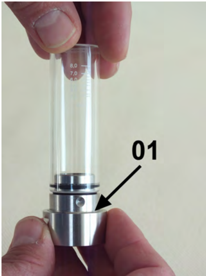
Abb. 44: Verschraubung (Eingang) in Schauglas
