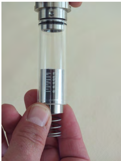
Abb. 39: Schwebekörper, Magnete und Feder entnehmen
