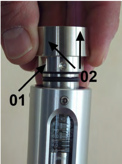
Abb. 50: Verschraubung (Ausgang) in Gerathuhule einsetzen
